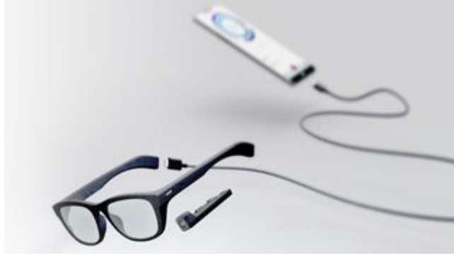
Şekil 13. Pupil Labs Invisible göz takibi cihazı
