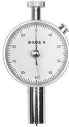
Şekil 3. 4. Shore A test cihazı [31].
