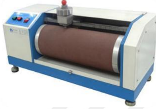
Şekil 3. 3. Aşınma Test Cihazı [30].
