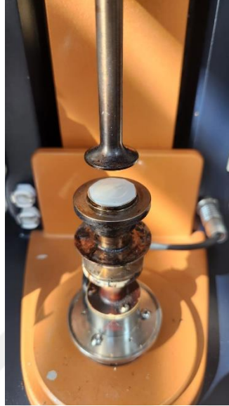
Şekil 4. 6. Reometredeki örnek yerleştiril şekli
