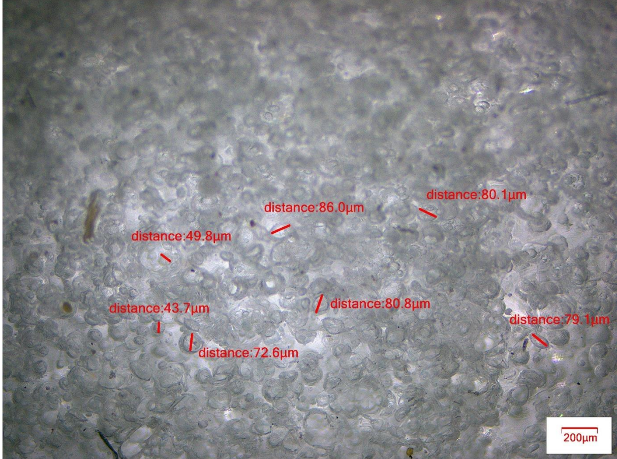
Şekil 4. 3. SBS-15 ve 2 phr fiziksel şişirici eklenmiş SBS polimerinin optikmikroskop görüntüsü.
