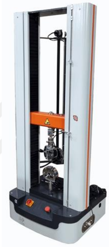
Şekil 3. 2. Çekme Test Cihazı [29].
