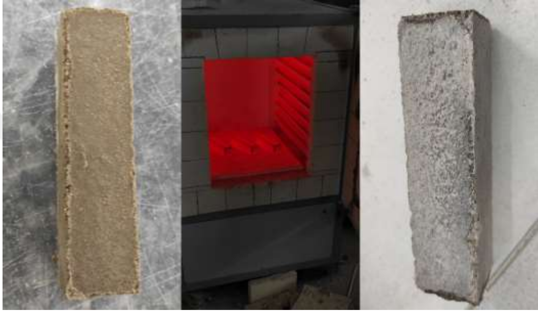
Şekil 3.6 Yüksek sıcaklığa maruz bırakılan numunelerin yüksek sıcaklık öncesi ve sonrası görüntüleri
