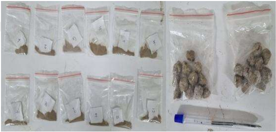
Şekil 2.21 FESEM incelemesi için hazırlanan numuneler
