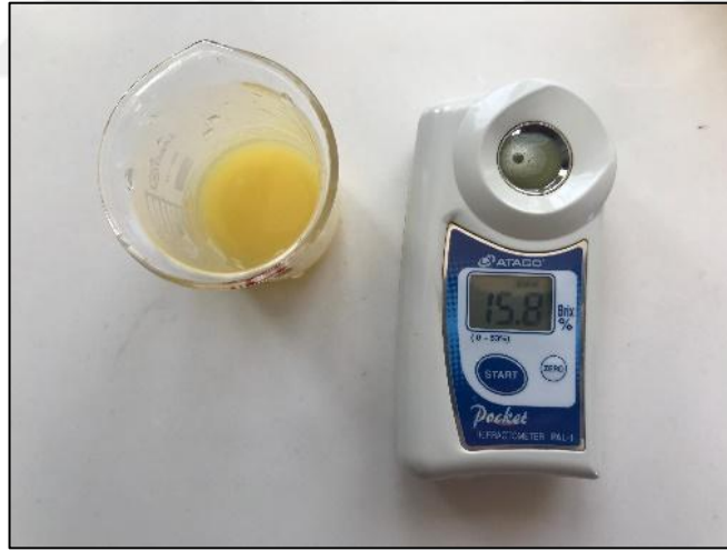
Şekil 3.6. Suda çözünür kuru madde miktarının (SÇKM) belirlenmesinde kullanılan refraktometre ve meyve suyu
