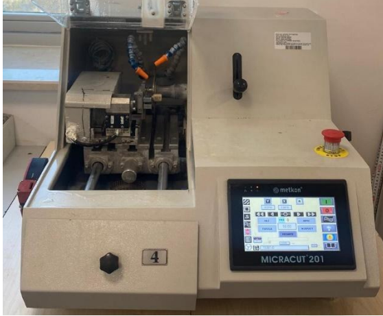
Resim 3.2. Hassas kesim cihazında seramik blokların kesilmesi
