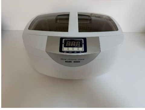
Resim 3.6. Örnek yüzeylerinin temizliğinde kullanılan ultrasonic temizleme cihazı
