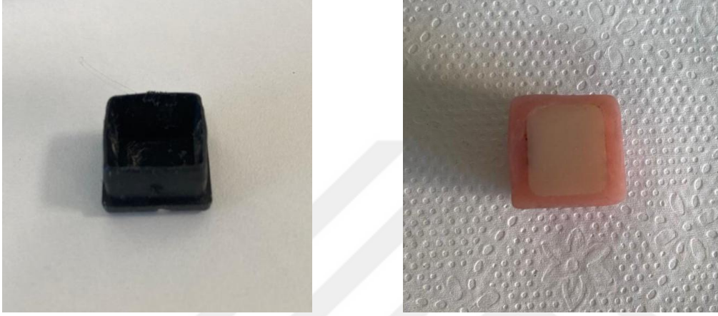
Resim 3.8. Kullanılan dikdörtgenler prizması kalıp ve akrilik rezin içine gömülen örnek
