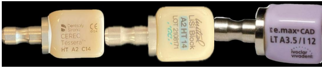
Resim 3.1. Çalışmada kullanılan seramik örnekler (a. IPS e.max CAD, b. CEREC Tessera ve c. GC Initial LiSi)6
