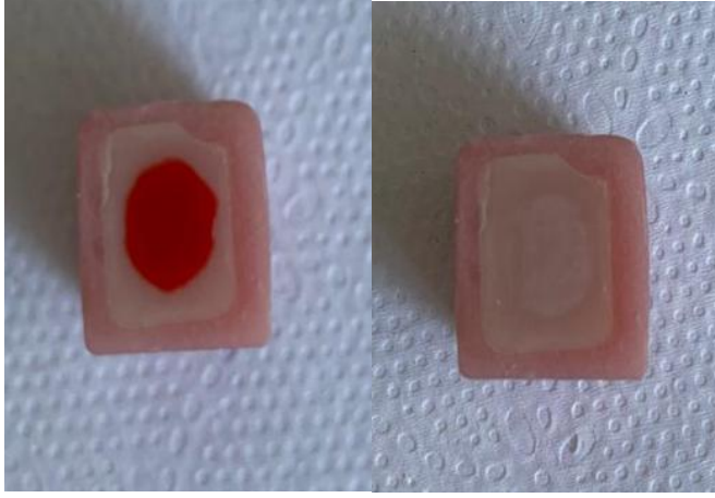
Resim 3.9. Seramik yüzeyine uygulanan hidroflorik asidin uygulanişı ve uygulandıktan sonraki seramik yüzeyi
