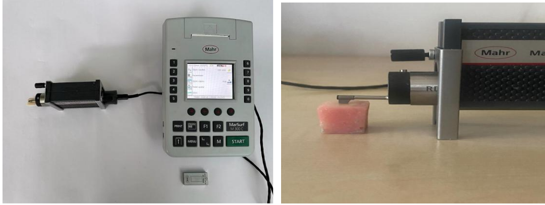
Resim 3.12. Profilometre ile yüzey pürüzlülüğü ölçümü
