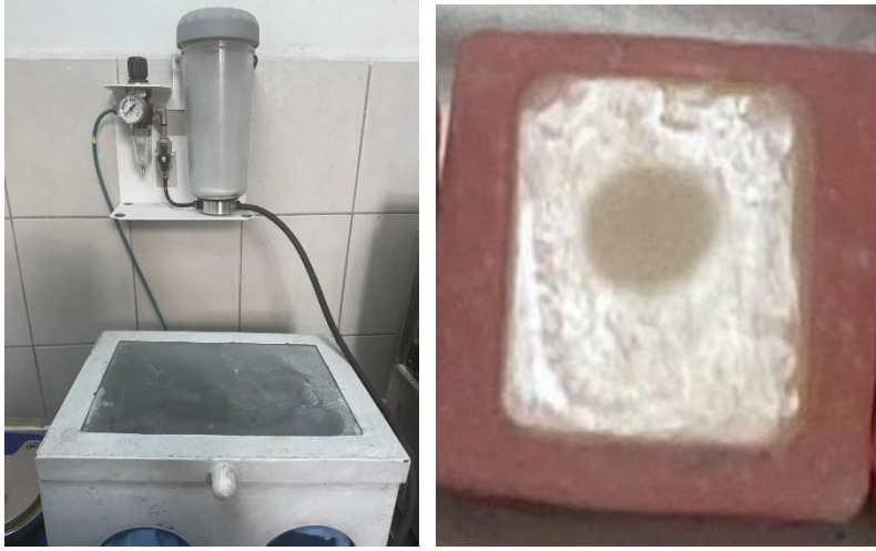
Resim 3.11. Kumlama cihazı ve kumlama yapılmış seramik yüzeyi
