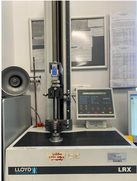
Resim 3.14. Örnekler üniversal test cihazı kullanılarak makaslama bağlanma dayanımı testi uygulanması
