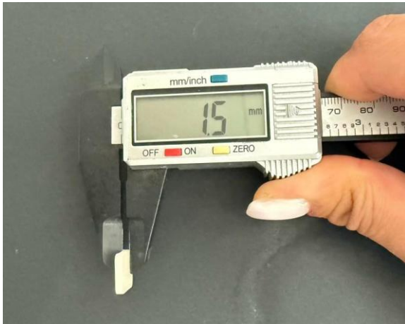
Resim 3.3. Örneklerin kalınlıklarının dijital kumpas ile ölçülmesi
