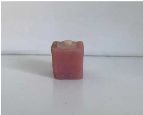
Resim 3.13. Akrilik blok içerisinde örneklere tamir materyali uygulanmış hali
