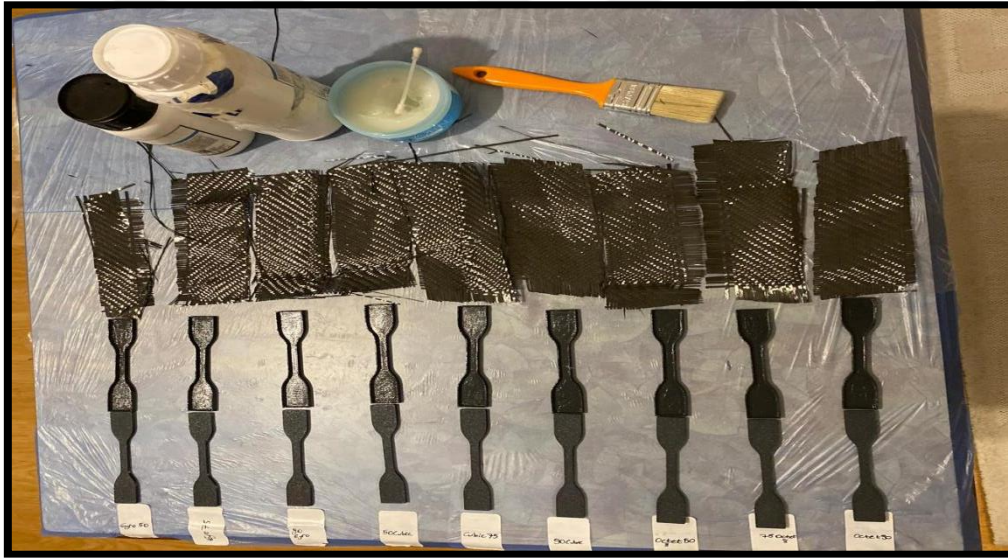
Şekil 4.10. Çekme numunelerine kaplama işlemi ön hazırlık-2
