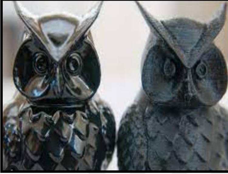
Şekil 3.9. Eklemeli imalatta son işlem adımı (Altan, 2019)
