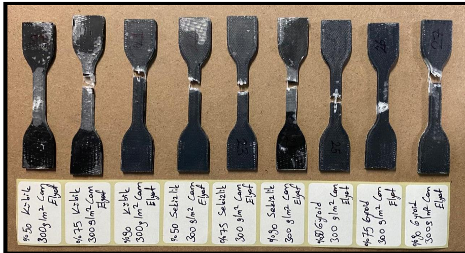
Şekil 5.18. Çekme testi sonrası 300 gr/m² cam elyaf kaplamalı numuneler
