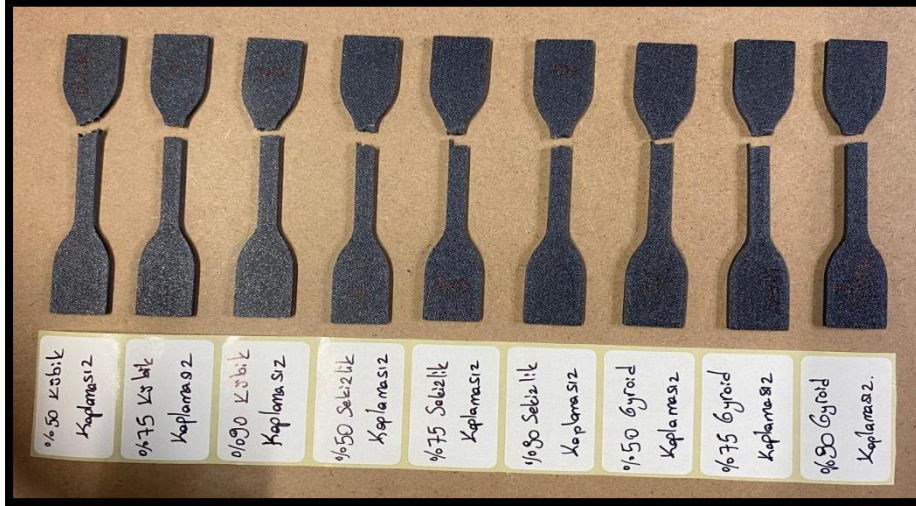
Şekil 5.16. Çekme testi sonrası kaplamasız numuneler
