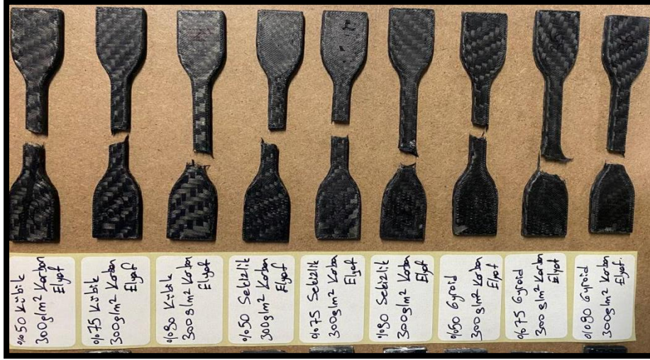
Şekil 5.19. Çekme testi sonrası 300 gr/m 2 karbon elyaf kaplamalı numuneler
