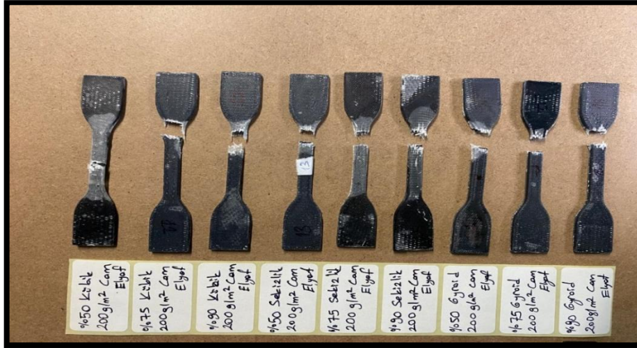
Şekil 5.17. Çekme testi sonrası 200 gr/m² cam elyaf kaplamalı numuneler
