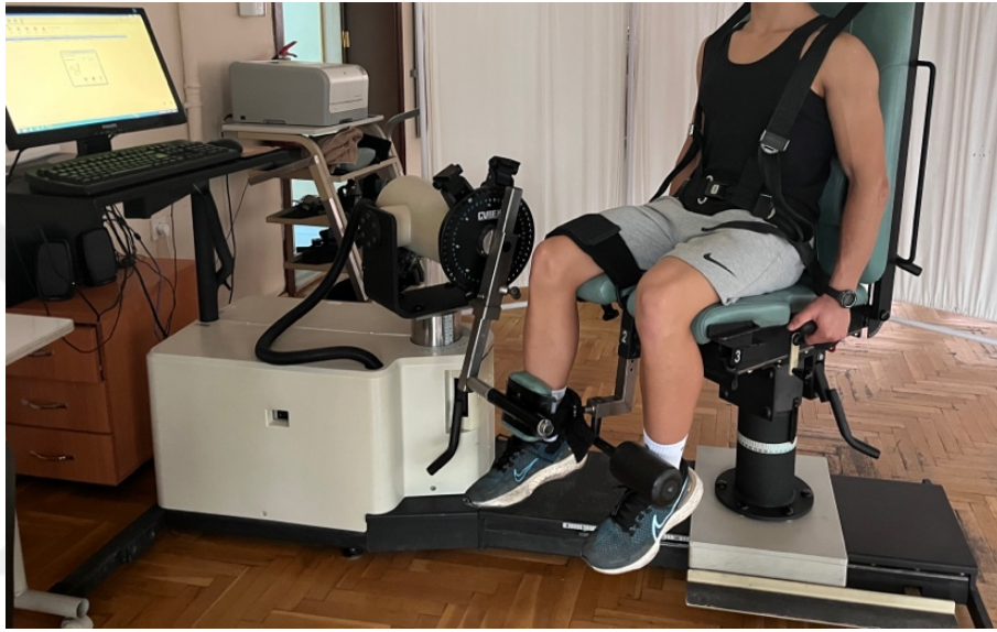
Şekil 3.1: Oturur Pozisyonda Diz Ekstansiyon-Fleksiyon İzokinetik Testi
