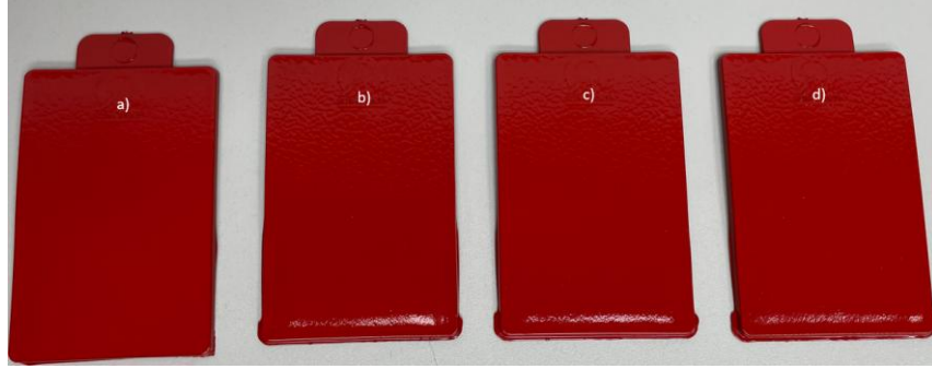
Şekil 5.7: Isıl yaşlandırma öncesinde UV stabilizatörü katkılı numunelerin yüzey görünümleri a) UV stabilizatörü katkısız, b) %2 UV stabilizatörü katkılı, c) %4 UV stabilizatörü katkılı, d) %6 UV stabilizatörü katkılı.
