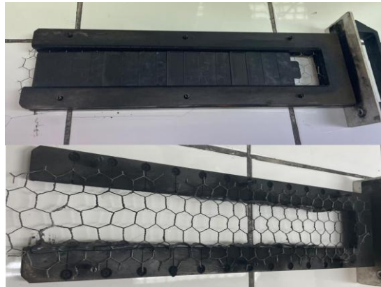
Şekil 4.25: Yanma testi öncesi ve sonrası numunenin yanma haznesindeki görünümü.
