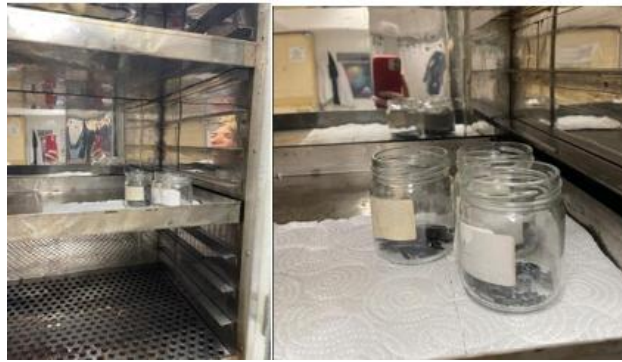
Şekil 4.21: Test numunelerinin 80 °C sıcaklıkta, 3 saat süreyle ön kurutma işlemine tabi tutulması.
