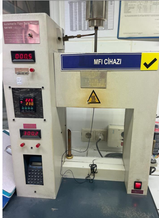
Şekil 4.23: MFI cihazı kullanılarak L mesafesinin ölçümü sırasında, plastik hammadde eriyik formda ekstrüde edilirken gösterimi.
