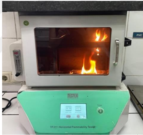
Şekil 4.24: Yanma testi kabinde numunenin konumlandırılması ve deney uygulaması
