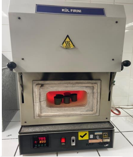
Şekil 4.26: Farklı oranlarda UV stabilizatörü katkısı içeren numunelerin kül fırını içerisindeki yerleşimlerinin gösterimi.
