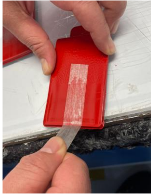
Şekil 4.29: Cross-cut testinde bant kaldırma uygulamasının gösterimi.
