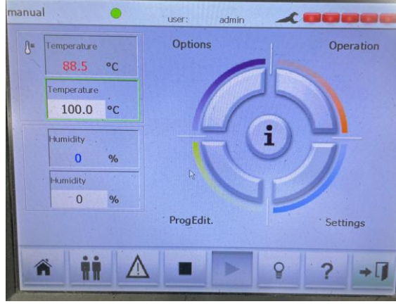
Şekil 4.32: Test kabini ekranında gözlemlenen sıcaklık ayarı (100 °C) ve nem oranı (%0).
