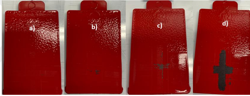
Şekil 5.8: Isıl yaşlandırma sonrasında UV stabilizatörü katkılı numunelerin yüzey görünümleri a) UV stabilizatörü katkısız, b) %2 UV stabilizatörü katkılı, c) %4 UV stabilizatörü katkılı, d) %6 UV stabilizatörü katkılı.
