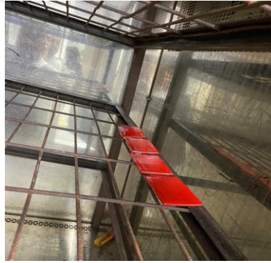
Şekil 4.31: Vötsch marka iklimlendirme kabininde ısıl yaşlandırma uygulaması.
