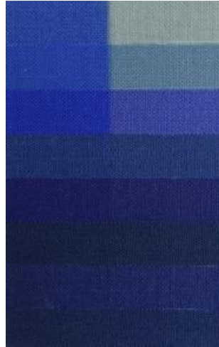
Resim 3. 5. Sağ tarafın 30 gün boyunca tam güneşe maruz kaldığı şeritin sol tarafının örtüldüğü mavi yün test şeridi (Telif Hakkı Catharine Ellis)
