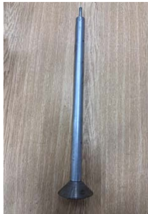
Şekil 3.5. Çan başlı ve düz model kazıklar
