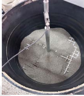
(c) Deney kumunun donatı üzerine serilmesi
