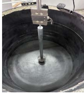
(a) Model kasesi içersine kazık yerleştirilmesi
