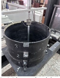
(a) Model kasası içerisine kazık yerleştirilmesi
