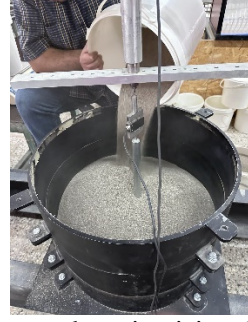
(b) Kumun kasa içerisine dökülmesi
