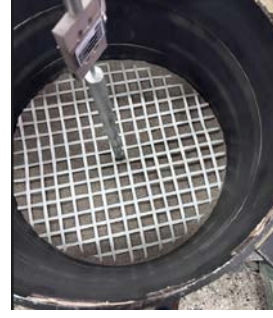
(b) Deney kum ve geogridin kasa içersine konulması
