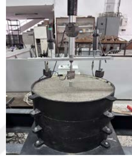
(d) Deney kumu ve donatı yerleştirilmiş hali
