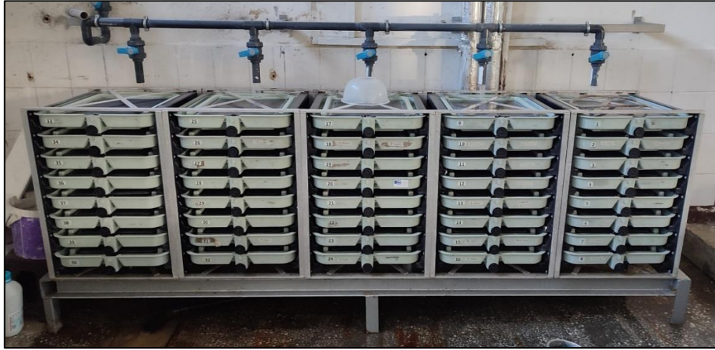
Şekil 3.3: Döllenmiş yumurtaların inkübasyonunda kullanılan vertikal akışlı sistem (Özgün).
