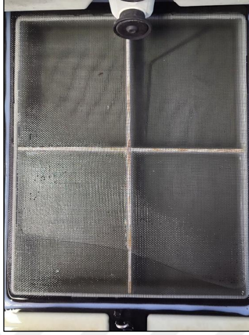
Şekil 3.4: Her kaset 40x33 cm ölçülerinde olup, 20x16,5 cm boyutlarında dört bölgeye ayrılmıştır (Özgün).
