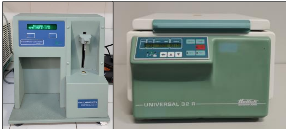
Şekil 3.8: Fiske® 210 Mikro-Numune osmometre ve Hettich Universal 32 R santrifüj cihazları (Özgün).
