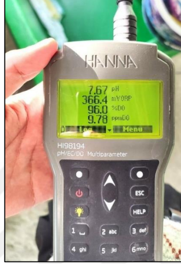
Şekil 3.6: Su parametrelerinin ölçülmesinde kullanılan multiparametre cihazı (Özgün).
