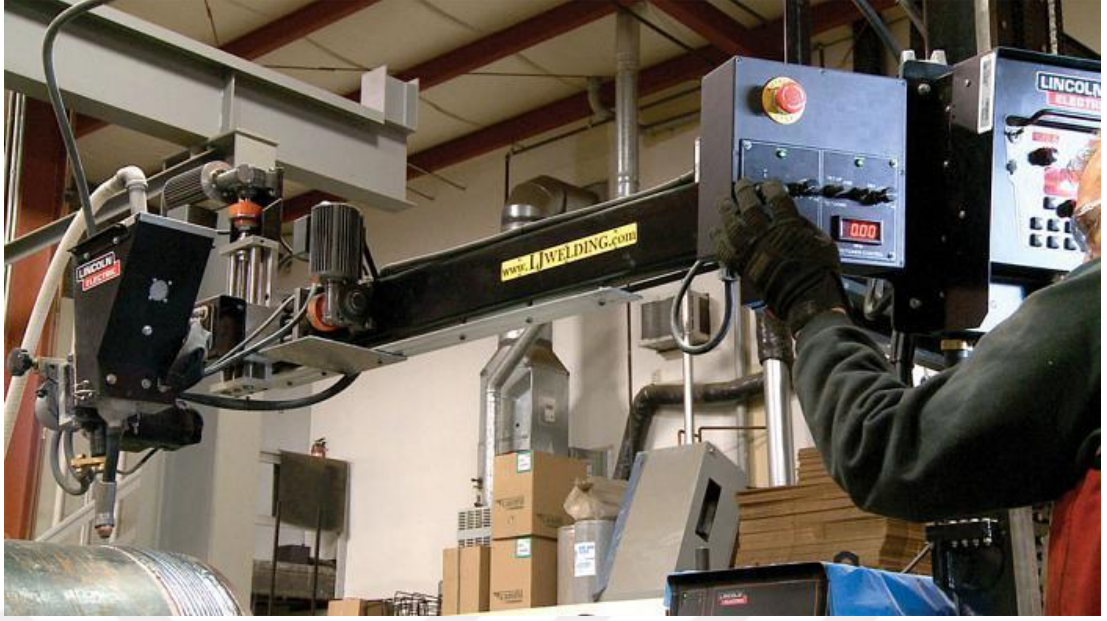
Şekil 2.2 : Kaynak torcunun manuel pozisyon kontrolü [22]
