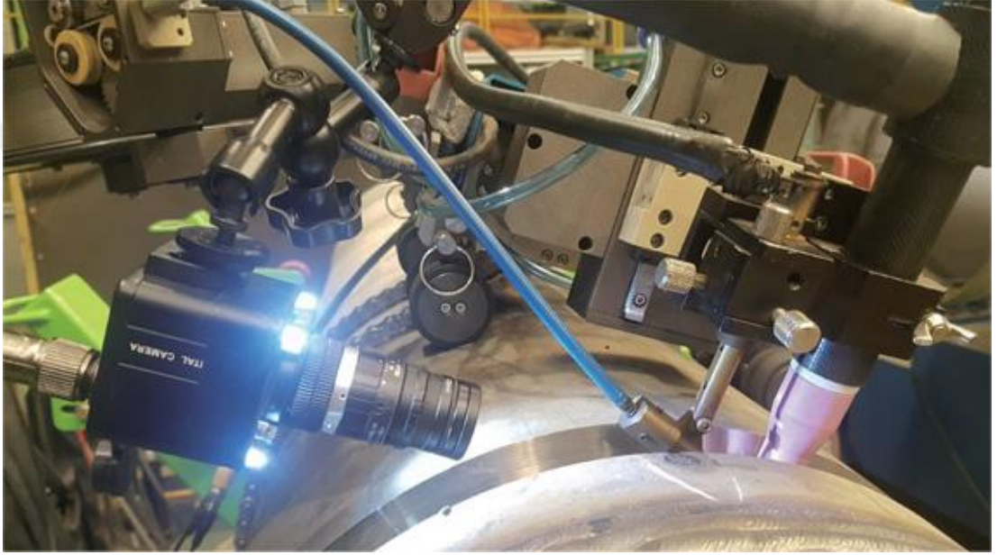
Şekil 2.5 : İki boyutlu kamera ile kaynak izi takibi [23]
