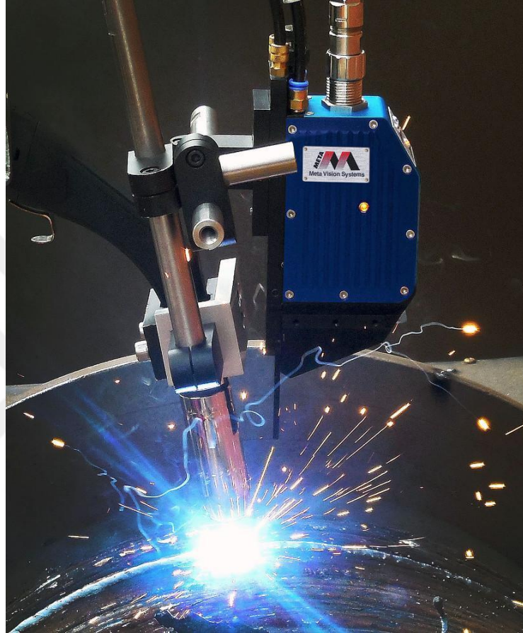
Şekil 2.7 : Lazer tabanlı kaynak izi takibi [25]
