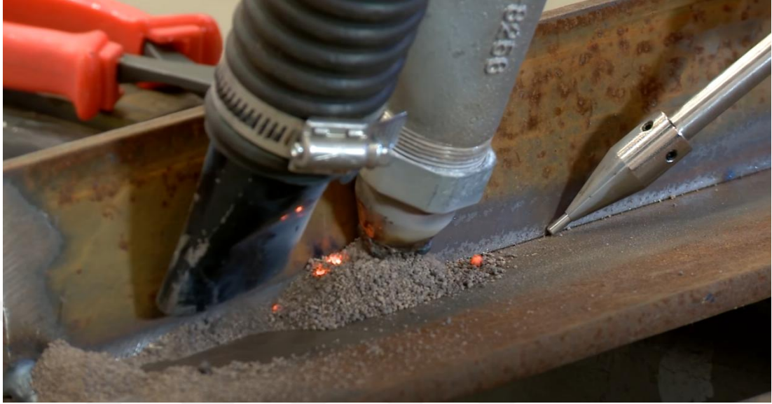
Şekil 2.6 : Kontak prob ile kaynak izi takibi [24]
