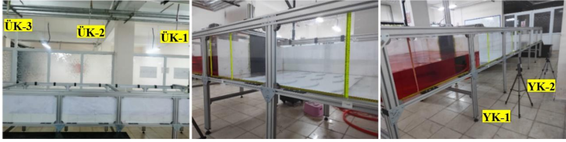
Şekil 3.33. Kanal 1'e ait yapısal ortamlar için deneysel ölçüm noktaları ve kameraların yerleşimi (ÜK: Üst Kamera ve YK: Yan Kamera)
