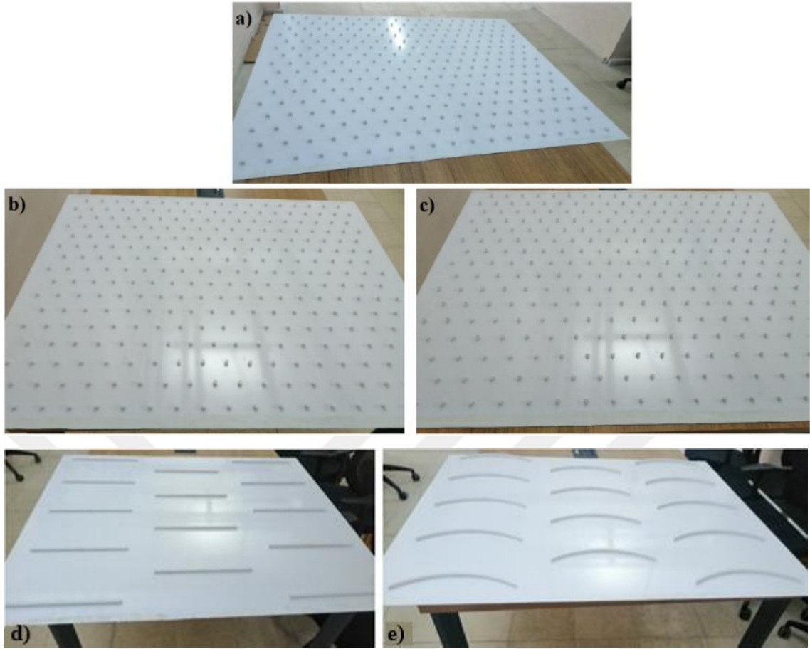
Şekil 3.13. Deneysel çalışmalarda kullanılan Kanal-1'e ait şaşırtmalı dizilimdeki yapısal ortamlar a) Tip YO-1.2 b) Tip YO-2.2 c) Tip YO-3.2 d) Tip YO-4.2 e) Tip YO-5.2
