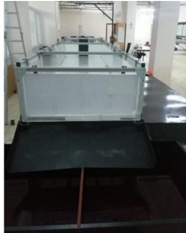
Şekil 3.53. Islak mansap yatağı deneyleri için Kanal-1'e ait mansap ucunun pleksiglas ile kapatılması
