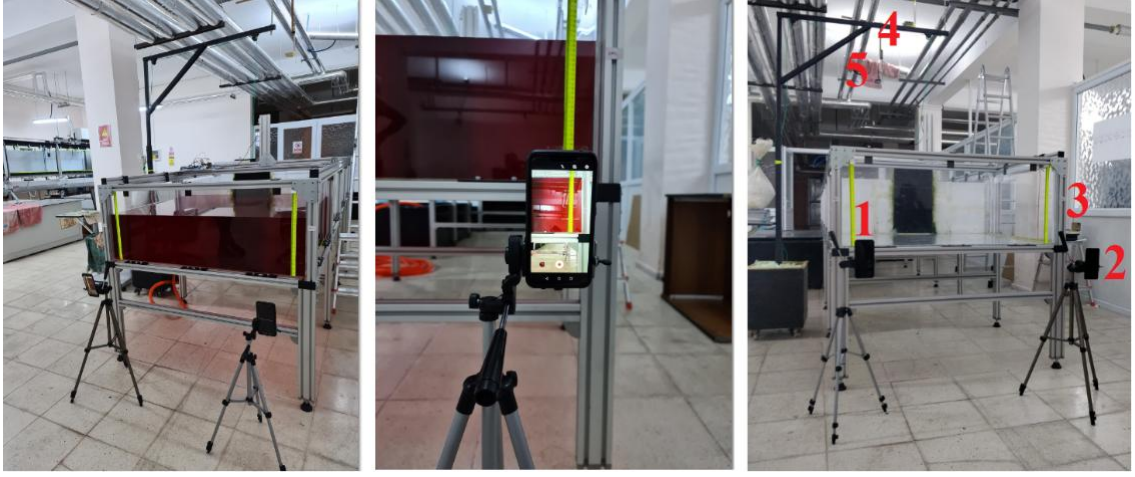
Şekil 3.31. Kanal-1’ait yapısız ortamlar için deneysel ölçüm noktaları ve kameraların yerleşimi
