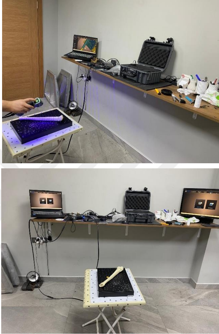
Şekil 27. Osteotomi modelinin 'FREESCAN COMBO' ile 3D taratılması
