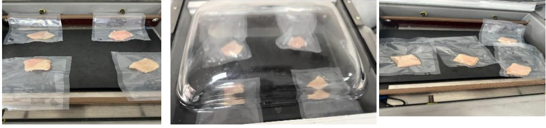
Şekil 3.2: Tavuk filetosunun vakum cihazında poşetle paketlenme aşamaları
