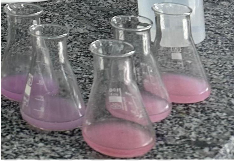
Şekil 3.9: Titrasyon işlemi sonrası açık pembe renk oluşumu
