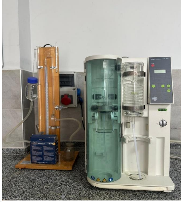
Şekil 3.10: Protein tayin cihazı gösterimi
