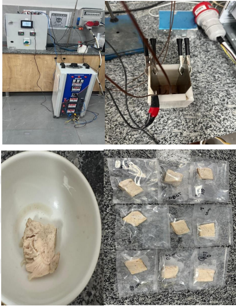
Şekil 3.7: Ohmik pişirme tekniğiyle pişirilmiş tavuk filetosu işlem aşamaları
