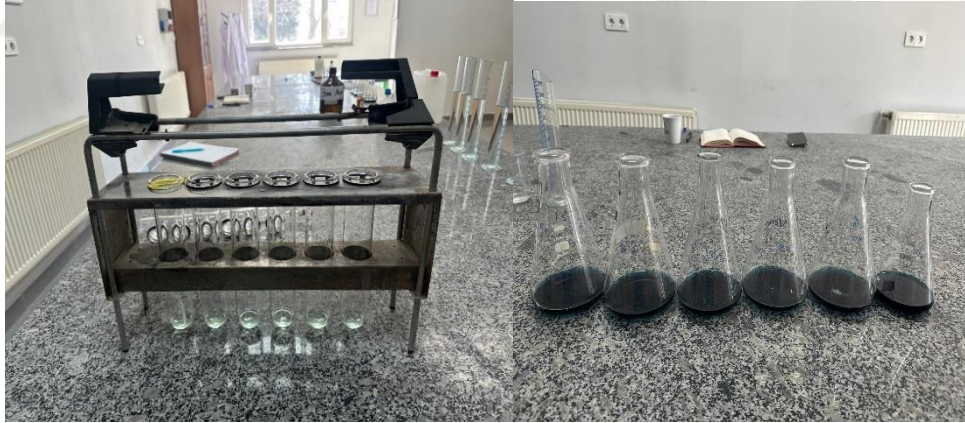
Şekil 3.9: Yanmış ve soğutulmuş protein örneği tüpleri
