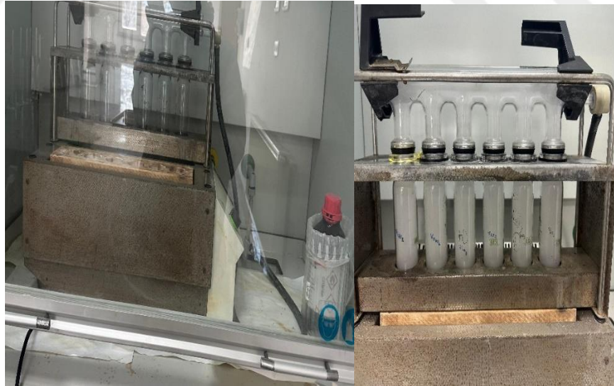
řekil 3.7: Protein yakma cihazı ve yanma iřlemi
