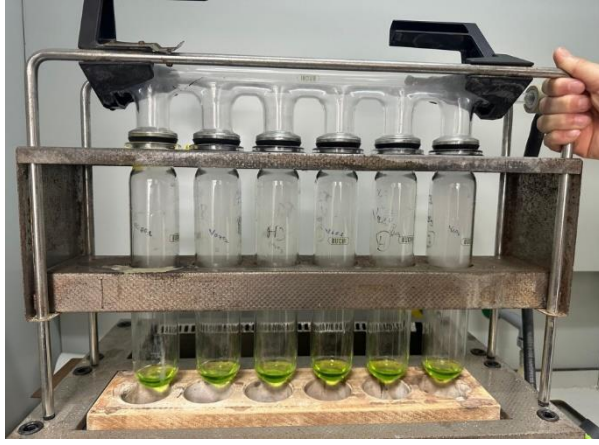
Şekil 3.8: Yanma işlemi gerçekleştirilmiş protein örneği
