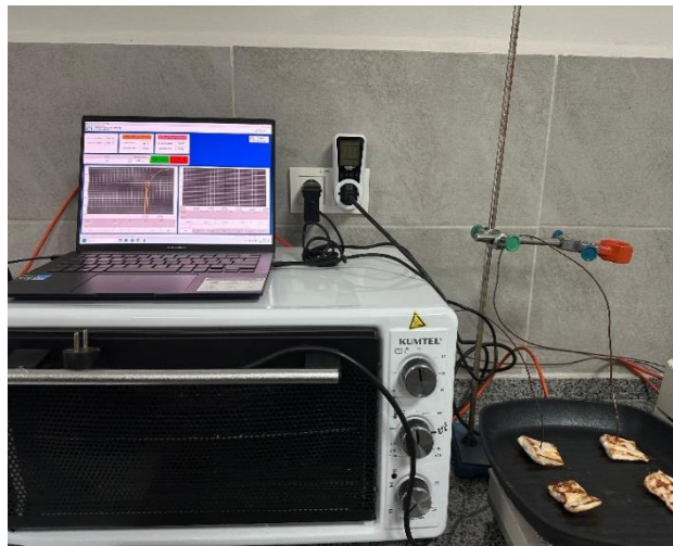
Şekil 3.8: Izgara yöntemiyle pişirme işlemi sırasında harcanan enerji ölçümü
