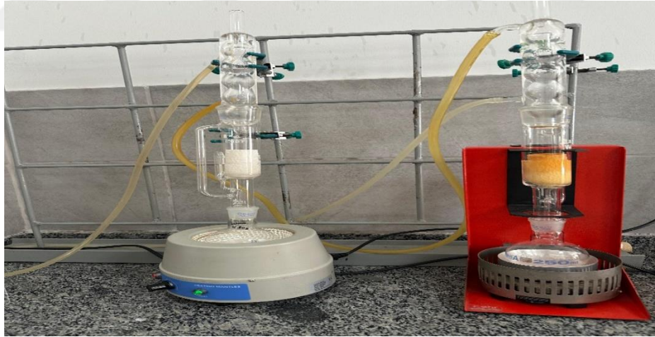
Şekil 3.5: Ham yağ Soxhlet ekstraksiyon cihazı ve toplama balonunda toplanan hekzan ve ham yağdan hekzanın tekrar kazanım düzeneği
