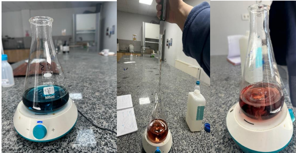
Şekil 3.11: Titrasyon işleminin aşamalı olarak gerçekleştirilmesi
