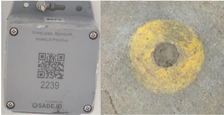
Şekil 3.2 Konum Sensörü – Gömülü ve Direk Üstü Uygulama
