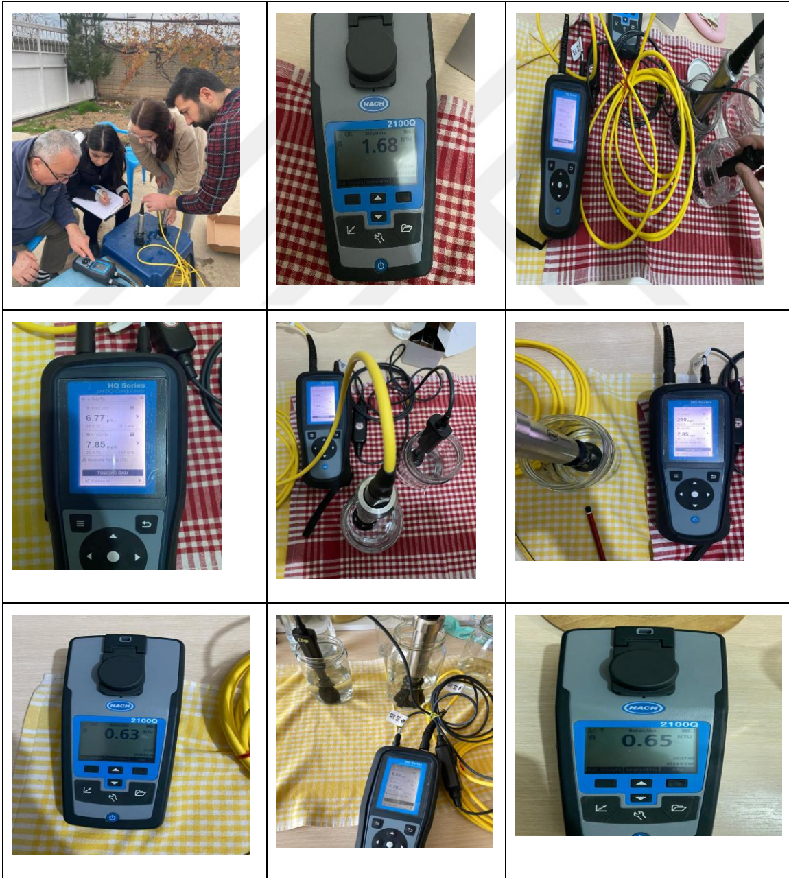
Şekil 8. Multi parametre probu(( pH, EC ve DO Propları) (HACH-HQ-Germany))
