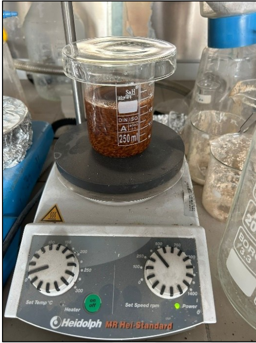
Resim 3.3. Öğütülmüş kuru ceviz kabukları-fosforik asit karışımı
