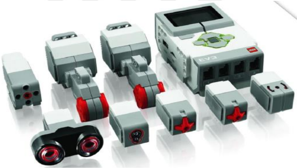
Şekil 5. LEGO Mindstorms EV3 Seti içinde bulunan motor ve sensörler
