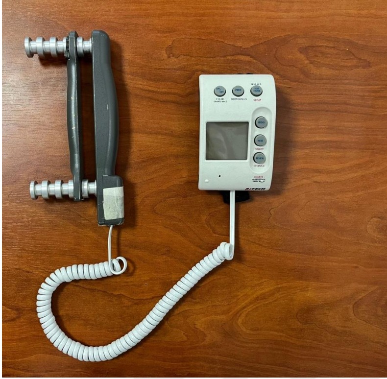
Resim 3.16. J-Tech (Midvale, ABD) El kavrama kuvveti ölçüm cihazı
