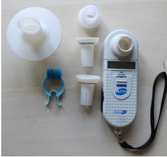
Resim 3.3. Micro Medical MicroRPM, İngiltere, ağız içi basınç ölçüm cihazı
