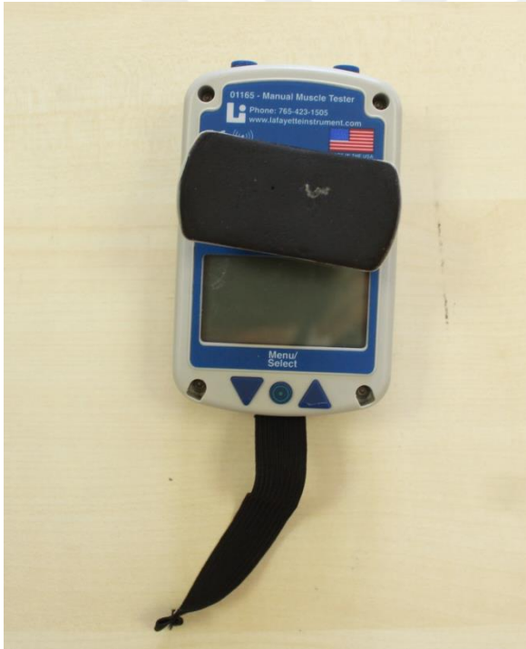
Resim 3.13. Lafayette-Manual Muscle Tester (Model: 01163) kas kuvveti ölçüm cihazı
