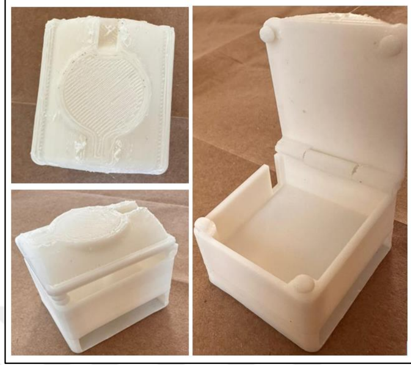
Şekil 51. Göğüs hareketi elektromekanik model 3B baskı
