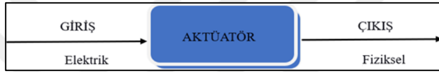
Şekil 6. Aktüatör çalışma diyagramı
