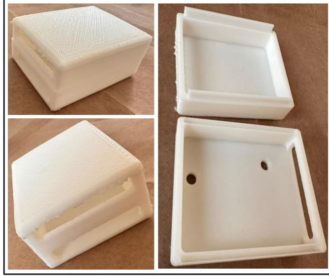
Şekil 54. Kontrol kart koruyucu kutu 3B baskısı
