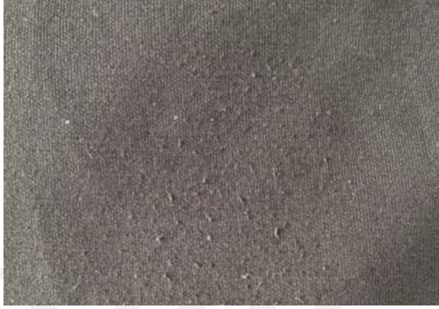
Şekil 2. Kumaş Üzerindeki Boncuklanma Görünümü
