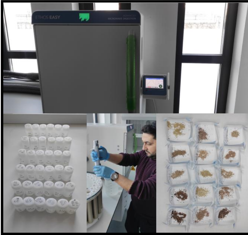
Resim 3.10. Örneklerin mikrodalga yakma ünitesinde yakılması işlemi
