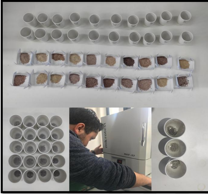
Resim 3.9. Örneklerin kül fırınında yakılması işlemi
