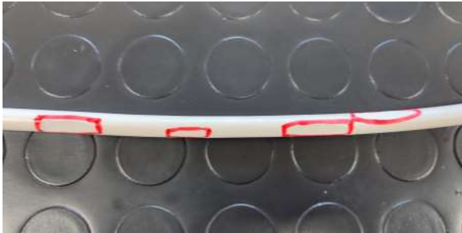
Şekil 3.3. Deneylerde kullanılan hatalı kablo örneği
