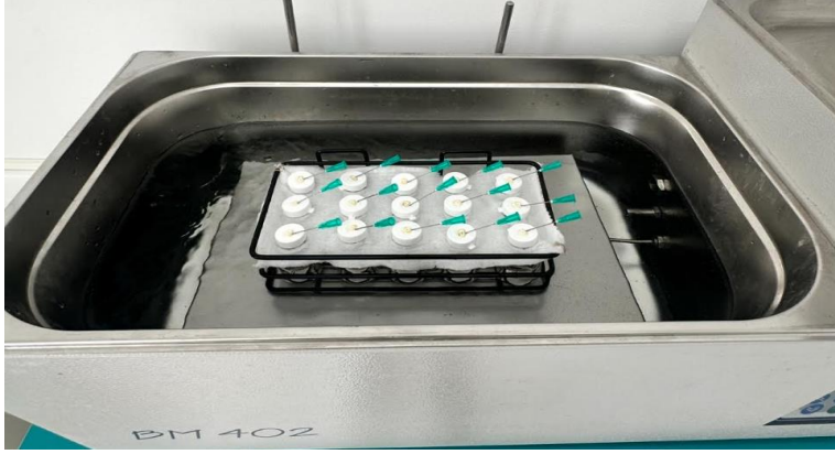
Şekil 3.6. Sıcak su banyosuna yerleştirilip sabitlenen düzenekler
