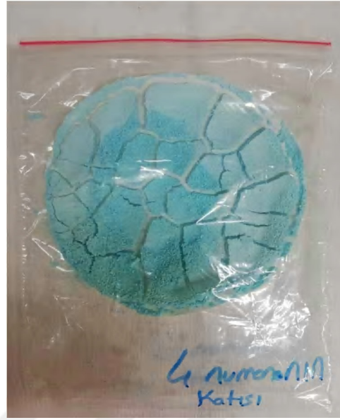
Şekil 18. Süzgeç kağıdında zenginleşen Cu(II)
