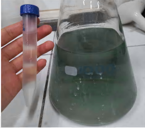
Şekil 15. İndigo Yıkama Suyu ile NCaSiL uygulamasından sonraki Süzüntü suyunun kıyaslaması
