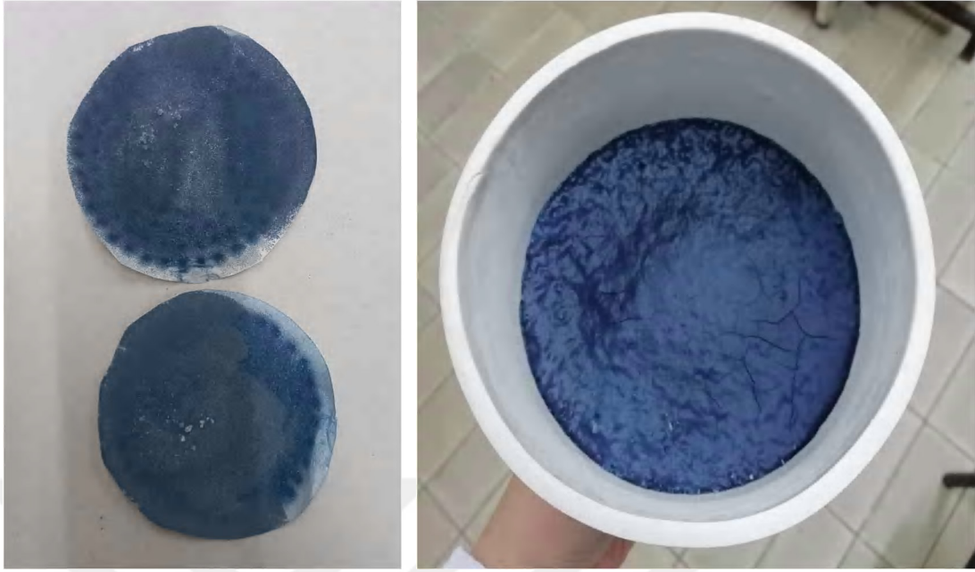
Şekil 20. ve 21. Yıkama suyundaki İndigo Boyanın NCaSiL ile Ayrılması ve Zenginleşmesi
