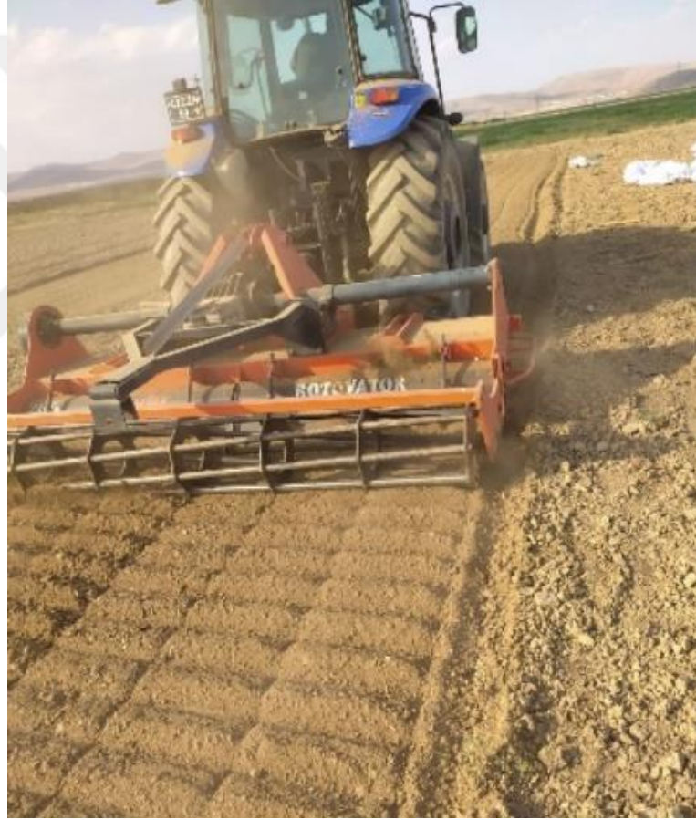
Şekil 3.5 Uygulama alanında Rotatiller kullanımı
