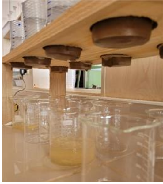
Şekil 3.9 Toprakların hidrolik iletkenlik durumunun belirlenmesi
