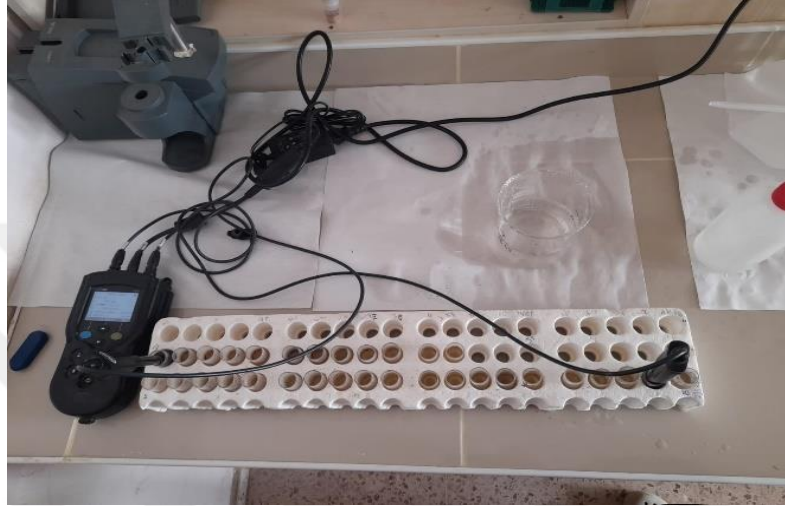
Şekil 3.11 Örneklerde pH ve EC okumalarının yapılması
