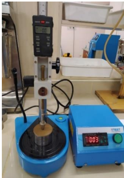
Şekil 3.10 Topraklarda likit limit-plastiklik limit belirlenmesi
