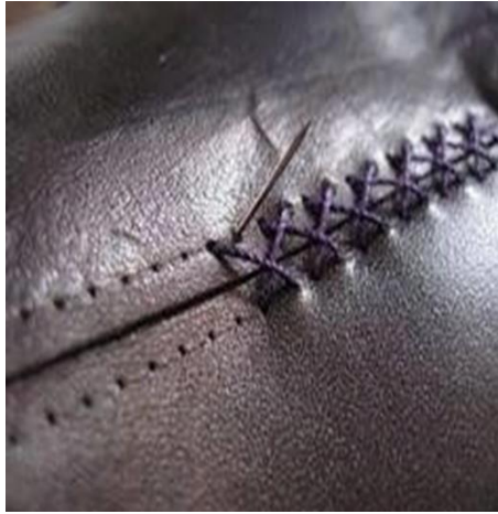
Resim 3.57. Dikiş Tekniđi İle Parça Birleştirme (İlknur Aytakin arşivi, Ankara, 2008)
