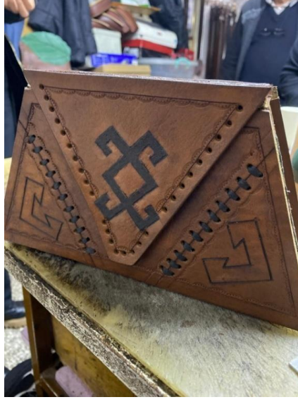
Resim 5.13. Çanta Önü Parça Birleştirme Dikiş Tekniği Örneği (İlknur Aytekin, 2024)
