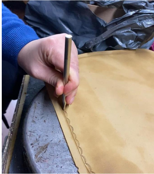
Resim 3.53. Soğuk Baskı Teknik Uygulama Örneği (İlknur Aytekin, Ankara, 2024)
