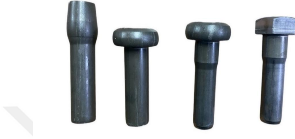
Şekil 2.3. Dört istasyonda cıvatanın şekillenmesi.
