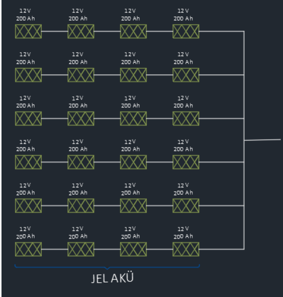
Şekil 6.4 Jel akü seçimi yapılarak tasarlanan akü bağlantı şeması
