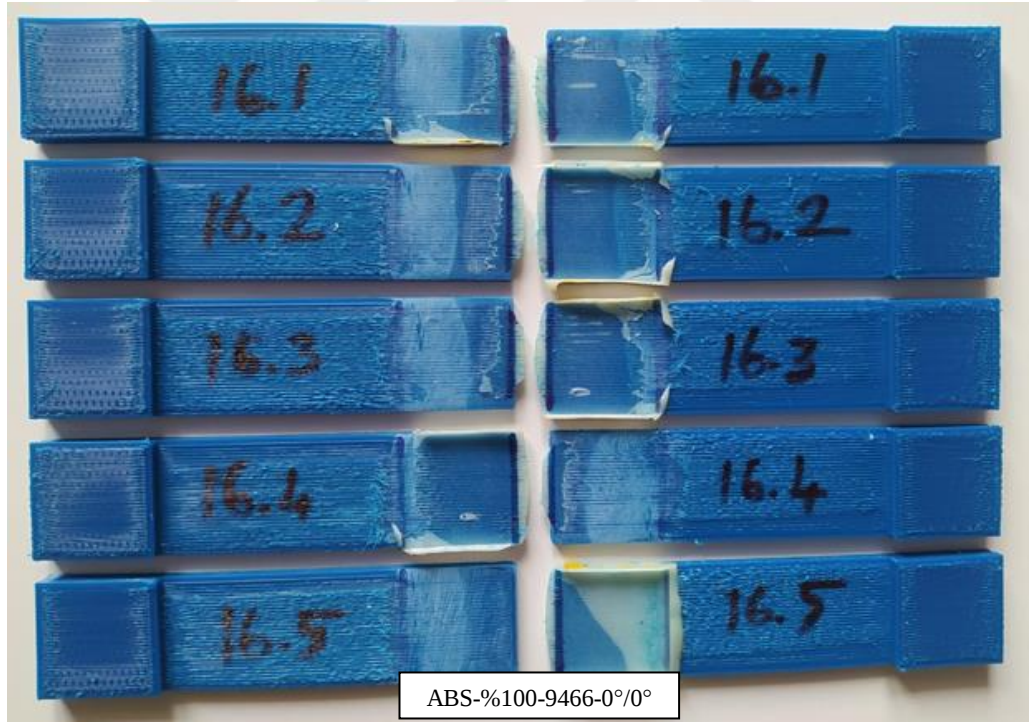
Şekil A.16. T-16 numunesi hasar şekilleri.
