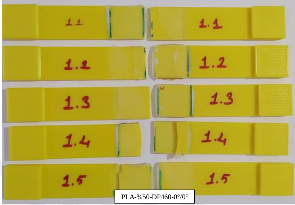
Şekil A.1. T-1 numunesi hasar şekilleri.
