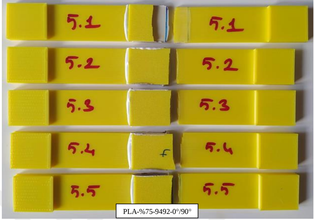
Şekil A.5. T-5 numunesi hasar şekilleri.
