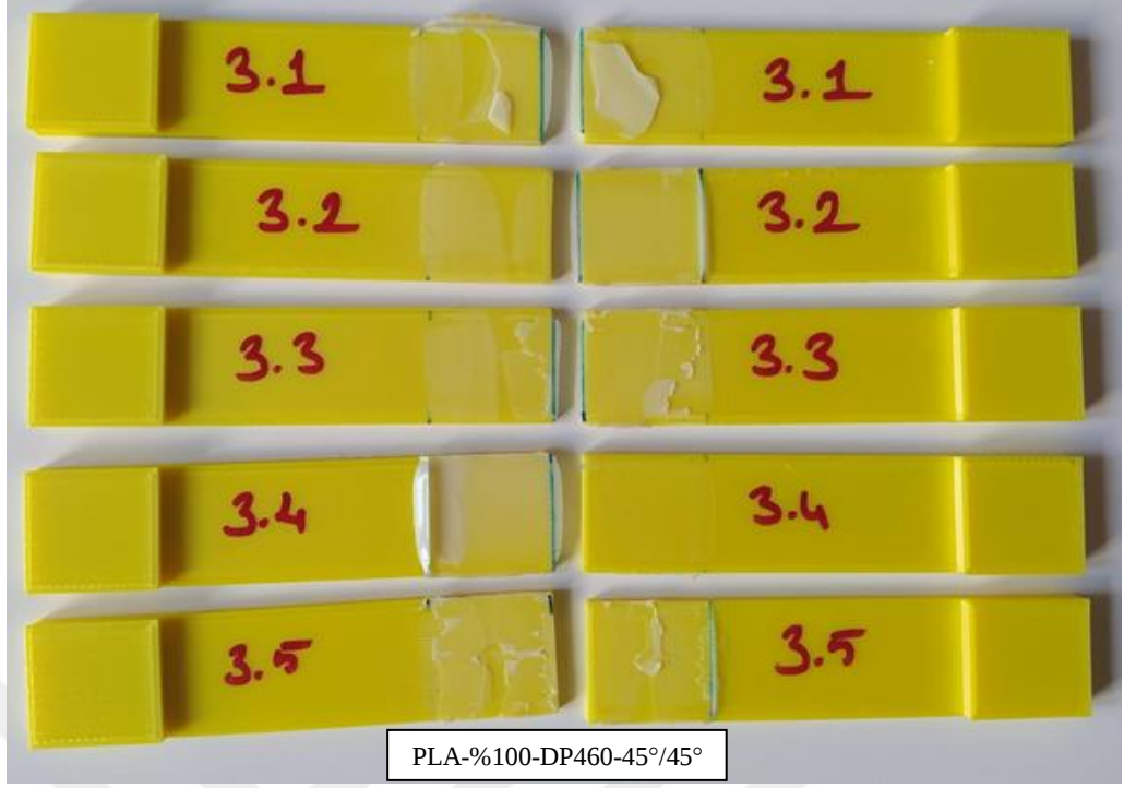
Şekil A.3. T-3 numunesi hasar şekilleri.
