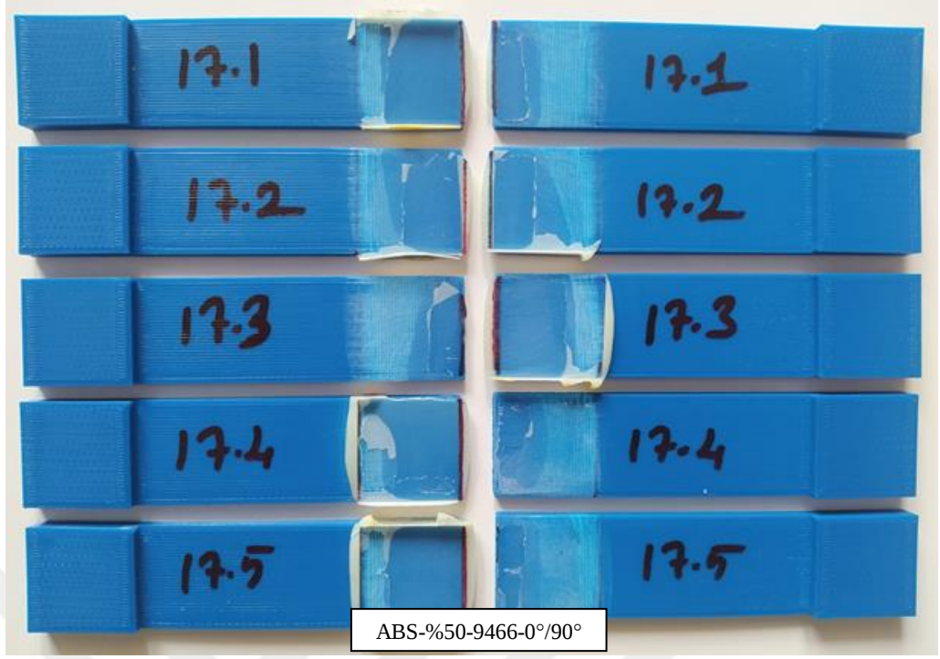
Şekil A.17. T-17 numunesi hasar şekilleri.
