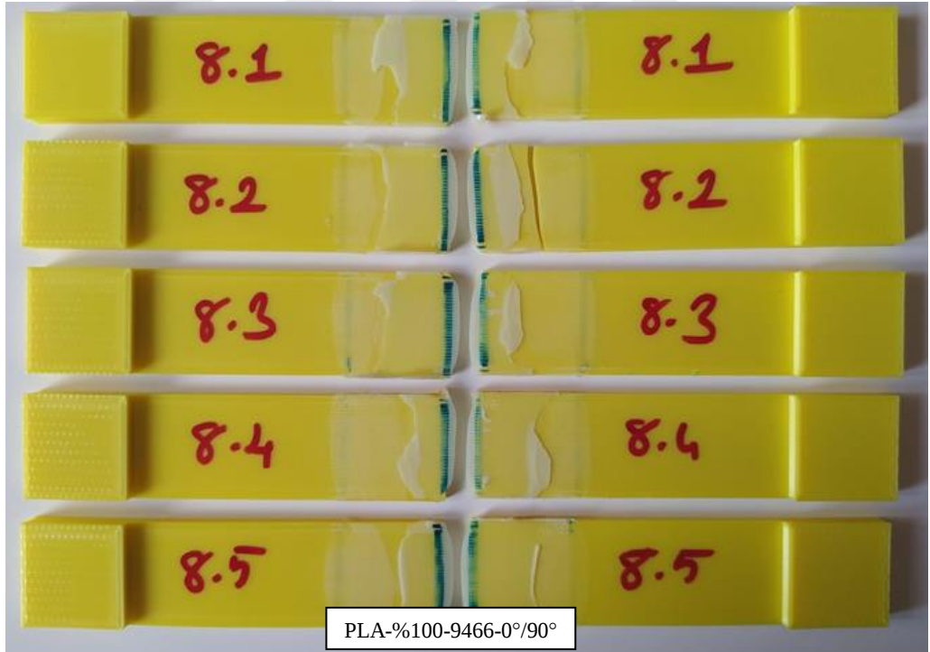
Şekil A.8. T-8 numunesi hasar şekilleri.
