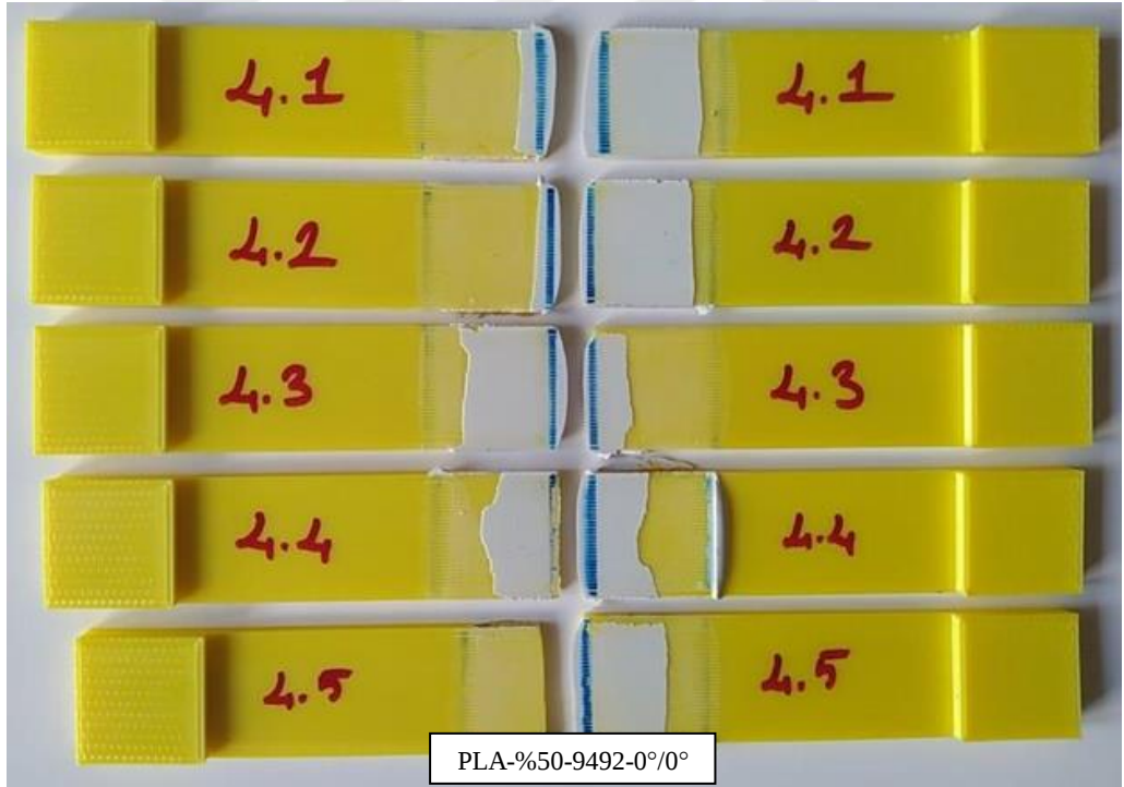
Şekil A.4. T-4 numunesi hasar şekilleri.
