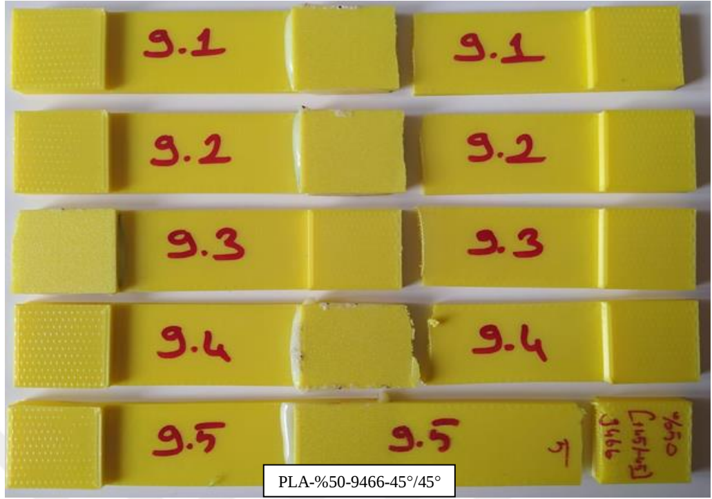
Şekil A.9. T-9 numunesi hasar şekilleri.
