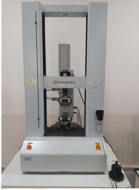
Şekil 4.8. Çekme deneylerinin uygulanması.
