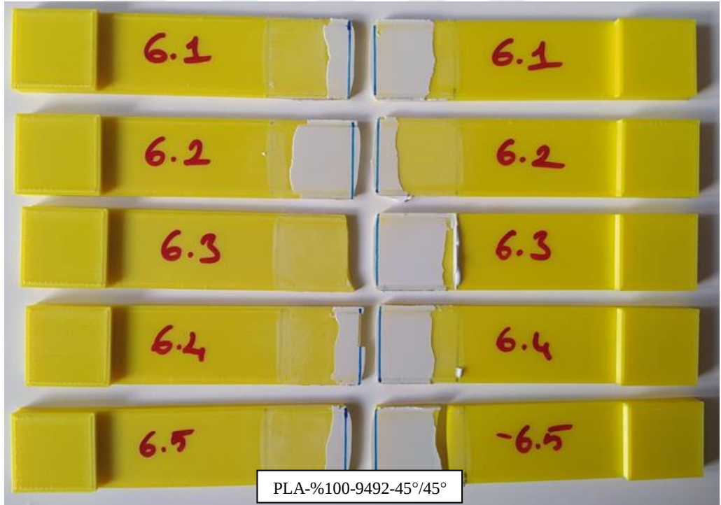
Şekil A.6. T-6 numunesi hasar şekilleri.
