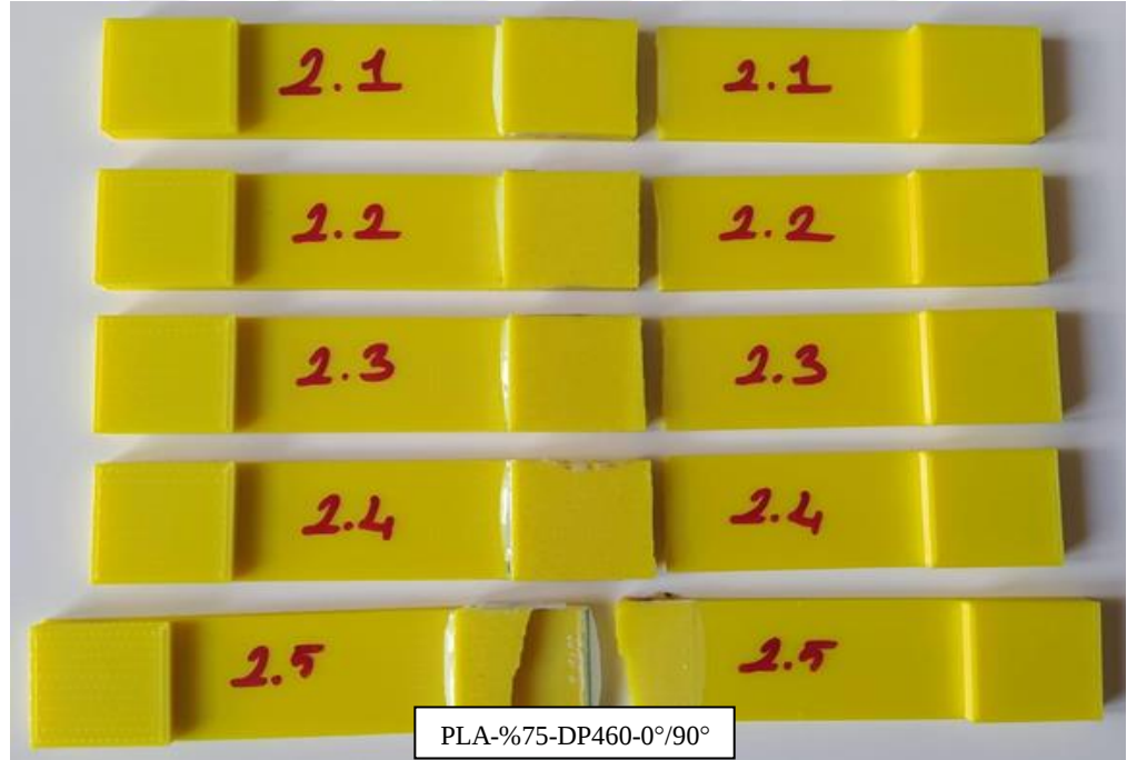
Şekil A.2. T-2 numunesi hasar şekilleri.
