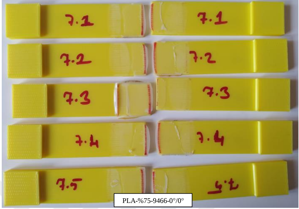
Şekil A.7. T-7 numunesi hasar şekilleri.
