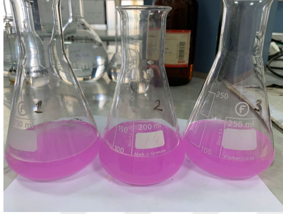
Şekil 2.4. Yağ asitlerinin NaOH ile titrasyonunun dönüm noktası rengi
