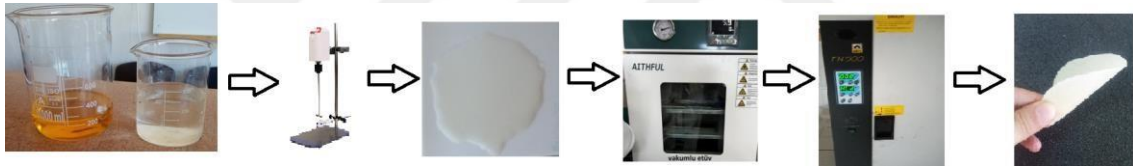
Şekil 3.2. Biyopolimer film yapım aşamaları
