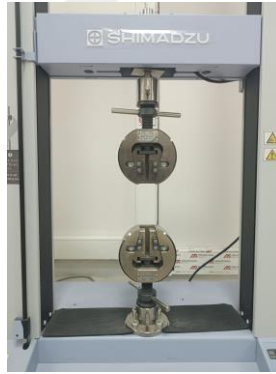
Şekil 3.3. Çekme testi cihazı
