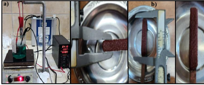
Şekil 8.23. a-Kalkopirit çözeltisinin elektroliz düzeneği, b- elektroliz sonucu alınan bakır.
