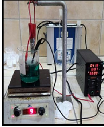
Şekil 8.10. Elektroliz uygulanan kalkopirit çözeltisi ve deney düzeneği.
