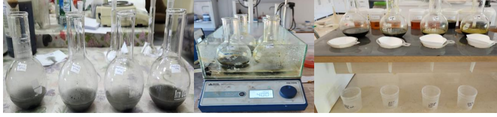
Şekil 8.8. Kavrulmuş kalkopirit numunelerinin asit liçi deney düzeneği.
