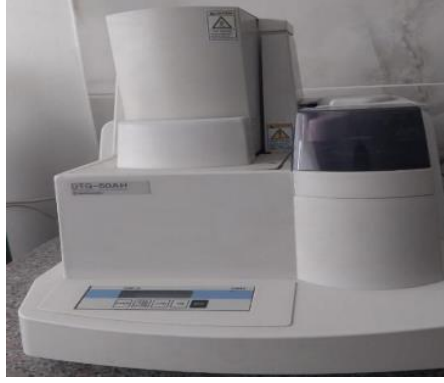
Şekil 6.8 Analizlerde kullanılan Shimadzu DTG- 60AH markalı cihaz.
