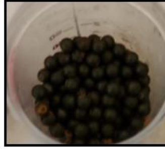
Şekil 8.2. Speks değirmende kullanılan çelik bilyalar.
