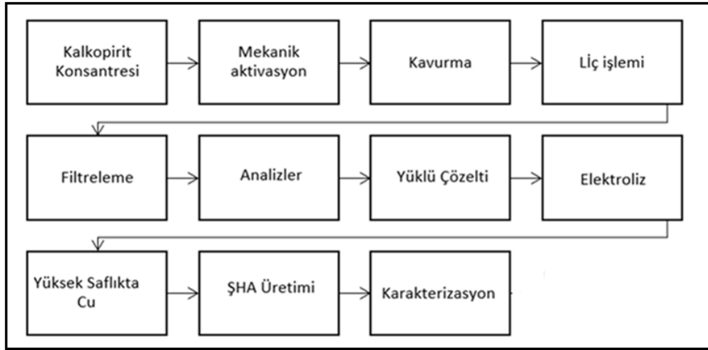
Şekil 8.11. Kalkopiritten metalik bakır üretimi ve üretilen bakırdan ŞHA üretiminde izlenen yol.
