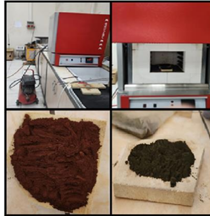
Şekil 8.6. İleri öğütme işlemi yapılmış numuneler 400, 500, 600 ve 700 °C de oksijen gazı verilerek 5, 10, 15, 30, 60 ve 120 dk kavurma işlemi.
