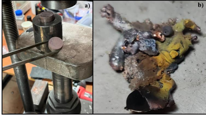
Şekil 8.24. a- CuAlMnMg ŞHA numunesinin briketlenmesi, b-ark eritme sonucu oluşan CuAlMnMg.
