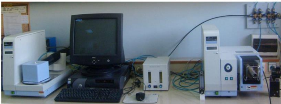
Şekil 6.7.Diferansiyel taramalı kalorimetri (DSC) cihazı [5].
