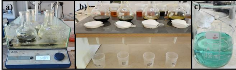
Şekil 8.22. a) Kalkopiritin liçi, b) liç sonrası süzme ve c) çözelti.
