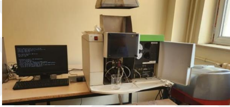
Şekil 8.9. AAS (Perkin Elmer, Analyst 400 Model) cihazı.
