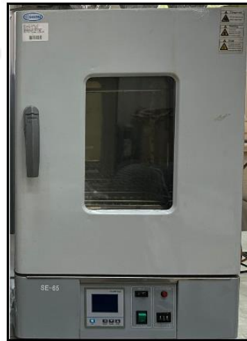
Şekil 8.1. Kurutma işlemlerinin yapıldığı Etüv.
