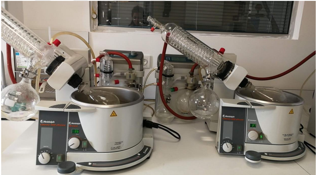
Şekil 3.4. Rotavapor cihazında ekstrelerin çözücülerinin buharlaştırılması işlemi.
