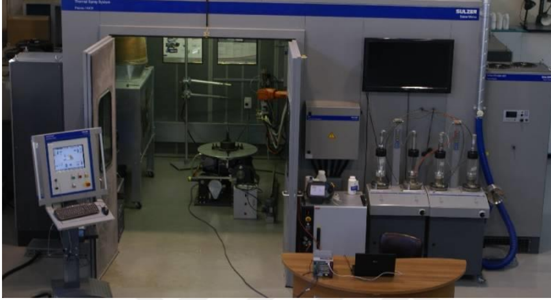
Şekil 4.17. Kaplamaların Uygulandığı Çoklu Kaplama Kabini.
