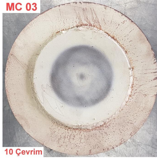
Şekil 6.5. MC 03 Kodlu Numunenin 10 Çevrim Sonrası Görünümü.
