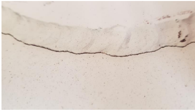
Şekil 7.1. MC02 Kodlu Numune Üzerindeki Hatalı Kaynak Detayı.
