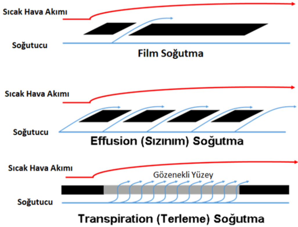
Şekil 3.20. Film, Sızınım ve Terleme Soğutma Şematik Gösterimi.
