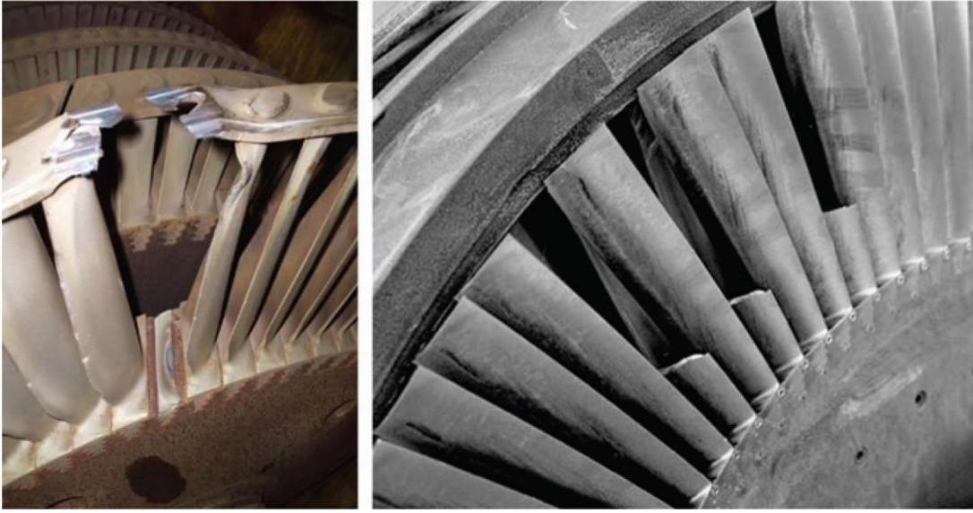
Şekil 3.23. Türbin Kanatlarında Fiziksel Yorulma Sonucu Oluşan Hasar.
