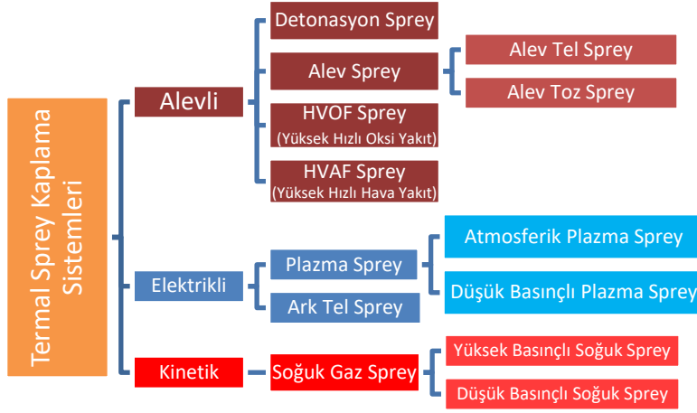
Şekil 3.11. Termal Sprey Kaplama Sistemlerinin Sınıflandırılması.
