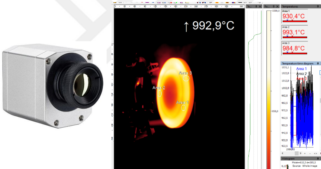
Şekil 5.2. Termal Kamera ve Deney Esnasında Yazılımdaki Anlık Görüntü.
