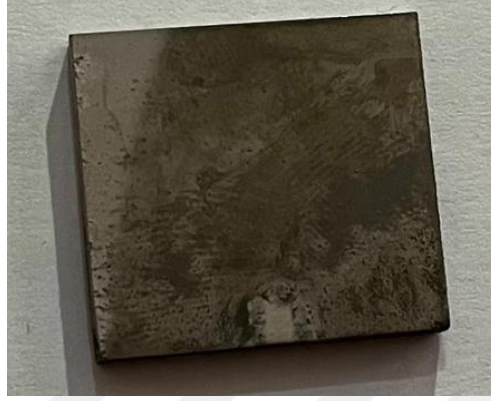
Şekil 5.7. Laboratuvar ortamında kaplanmış olan Ni-W kaplama numunesi.
