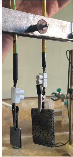
Şekil 5.6. Nitrik asit karışımına bandırılan numune ve elektrotlar.
