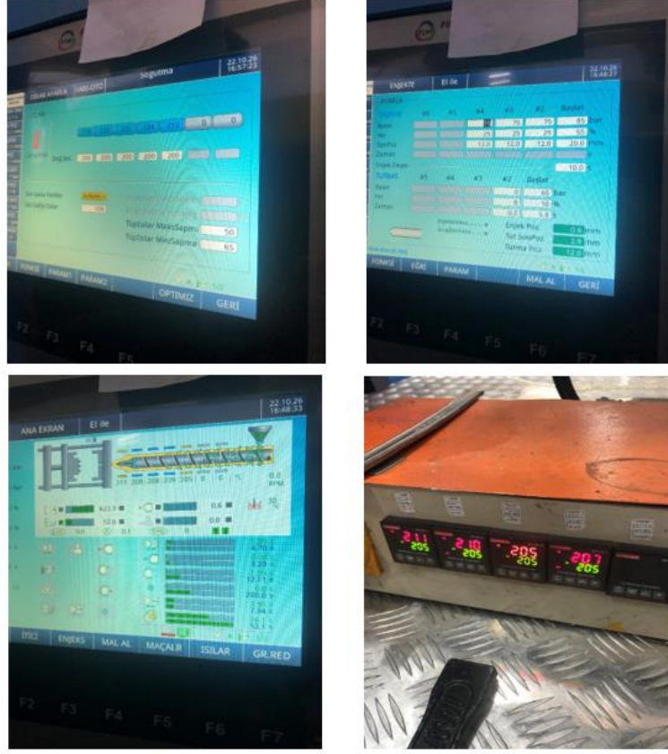
Şekil 2.12 Enjeksiyon prosesi parameter gösterimi
