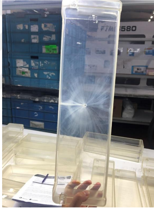
Şekil 2.14 Enfeksiyon akış izi hatası
