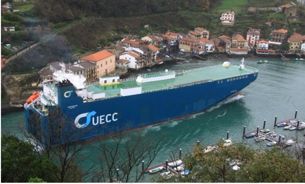
Şekil 2.9: UECC ye ait 2000 yapımı Autosun Gemisi ( 2285 araç kapasitesiyle UECC filosunun orta büyüklükteki PCTC gemilerinden biridir) [1]
