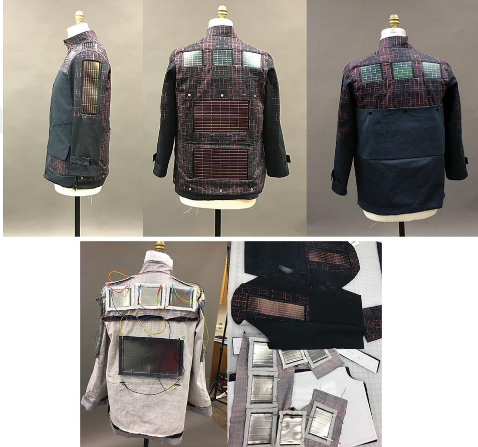
Görsel .26: Cihazları Şarj Etmek İçin Güneş Enerjili Bir Yürüyüş Ceket (Campbell, erişim tarihi: 12.02.2020)
