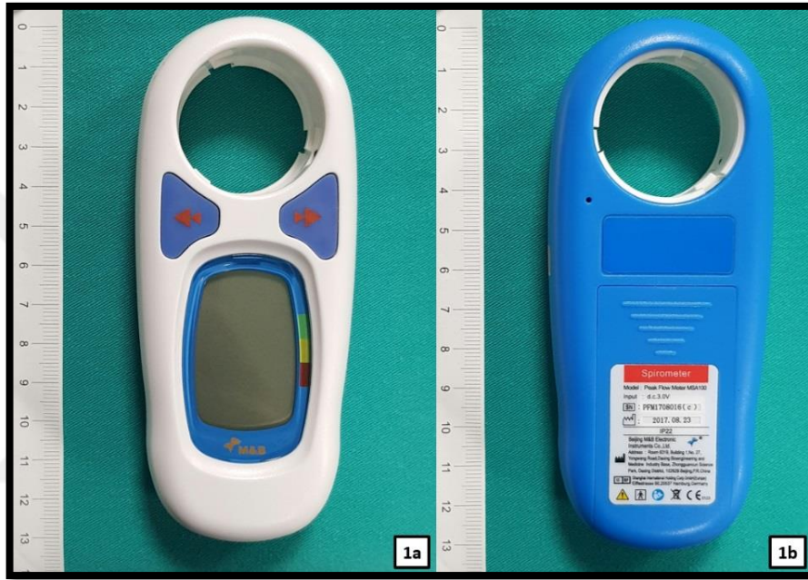
Şekil 1a. Ölçümler için kullanılan dijital PEF-metre ana ünitesinin ekran barındıran ön yüzünün görünümü.
