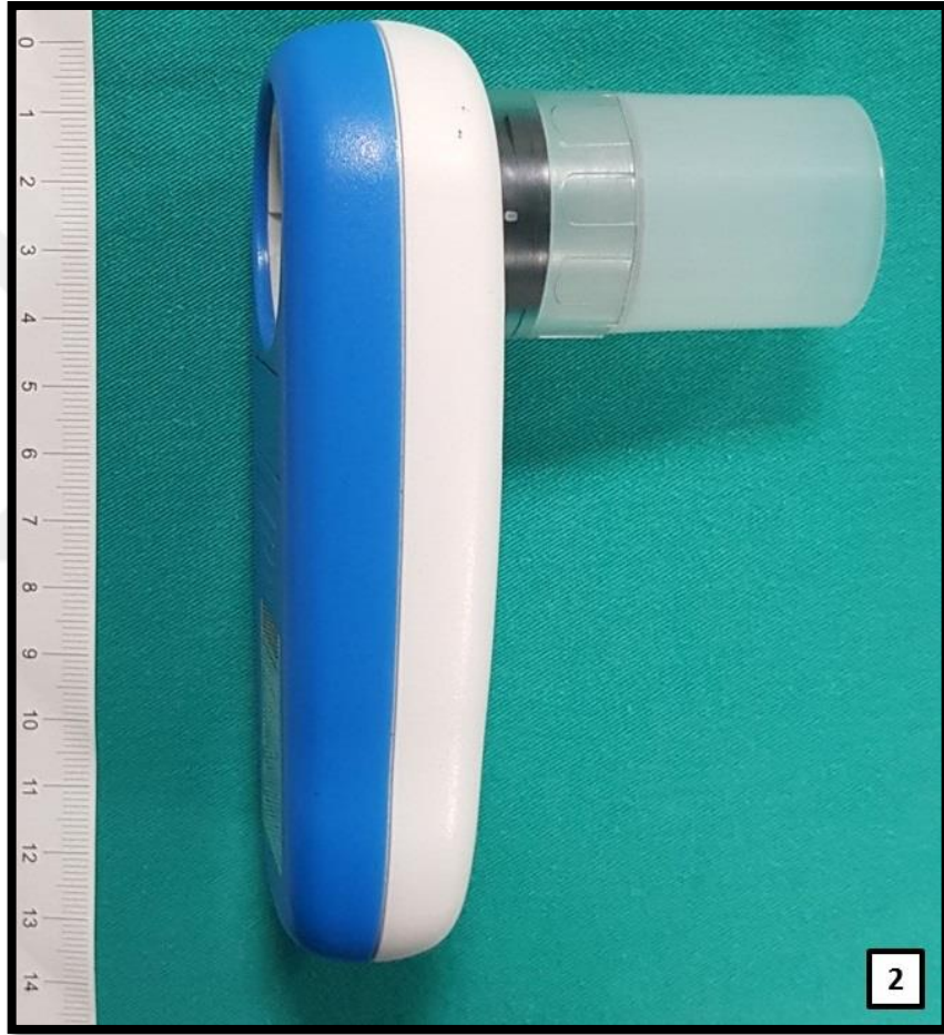
Şekil 2. Türbin, standart ağızlık ve ana ünitenin monte görünümü
