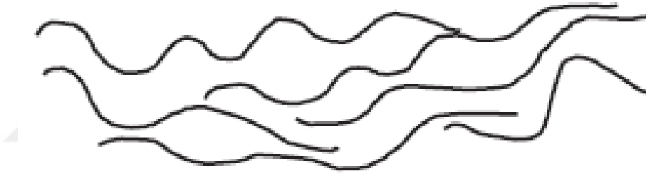
Şekil 3.1 Termoplastiklerin şematik zincir yapısı [54]
