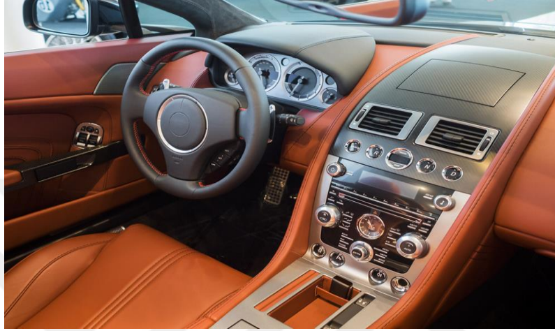
Şekil 3.10 Poliüretandan yapılmış otomobil göstergeleri [63]
