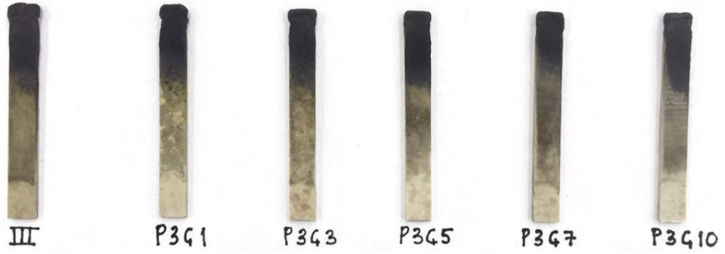
Şekil 6.10 UL-94 dikey yanma testi sonrası üçüncü seri kompozit numunelerin görünümü
