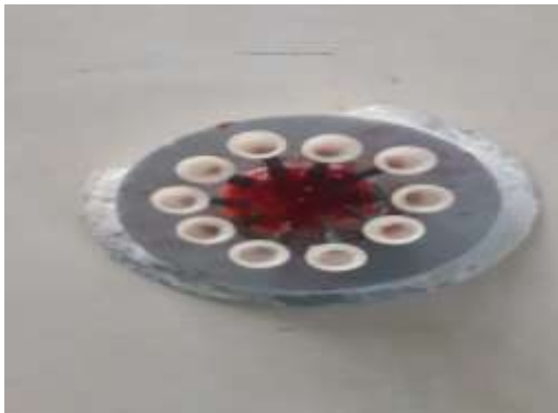
Resim 3.10. Döküm kanalına bağlanan PMMA alt yapılar
