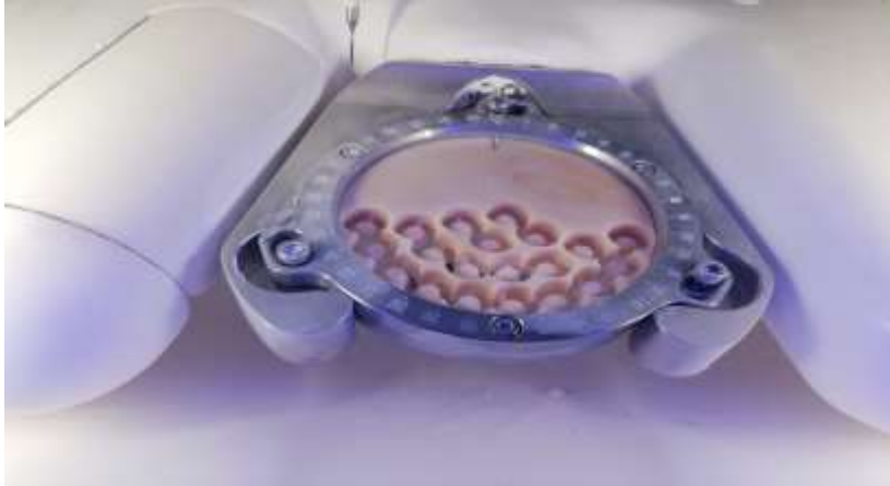
Resim 3.8. PMMA alt yapıların frezelenme aşamasına ait görüntü
