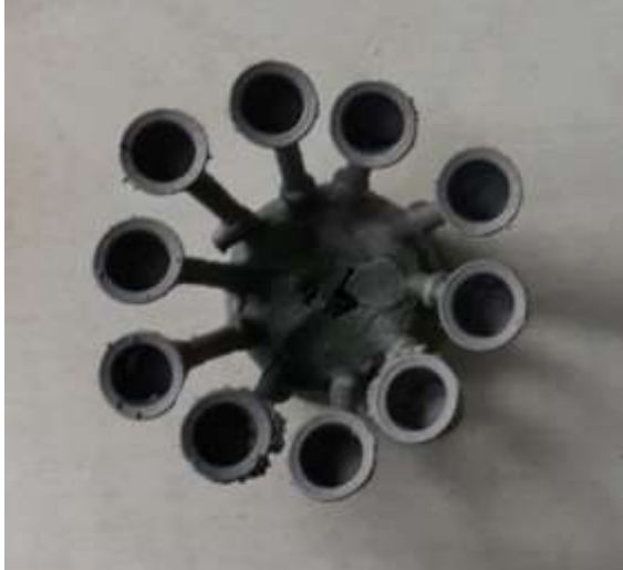
Resim 3.12. Döküm işlemi tamamlanmış olan Cr-Co örnekler
