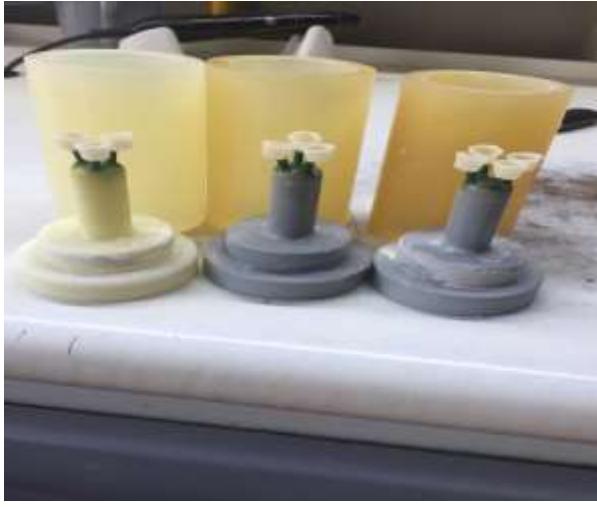
Resim 3.13. Tijlere tutturularak döküm konisine bağlanmış PMMA alt yapılar
