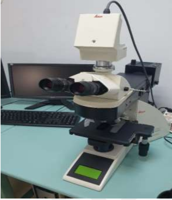
Resim 3.37. Silikon replikalara ait ölçümlerin yapıldığı ışık mikroskobu
