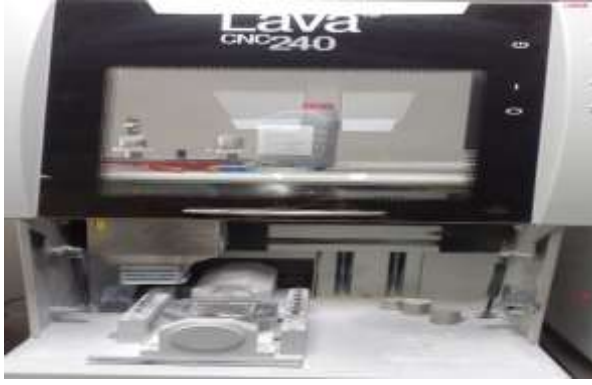
Resim 3.18. Zirkonyum oksit alt yapıların üretildiği freze ünitesi
