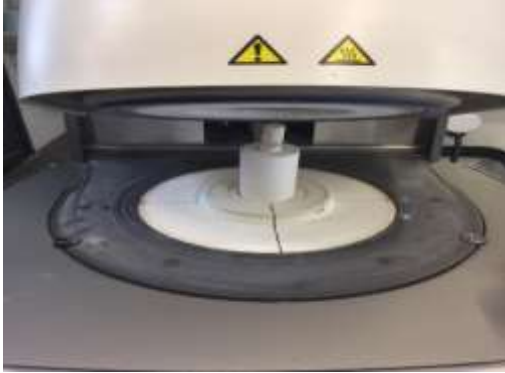
Resim 3.15. Presleme işleminin yapıldığı fırın
