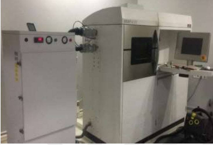
Resim 3.17. Eosint M270 lazer sinterleme cihazı
