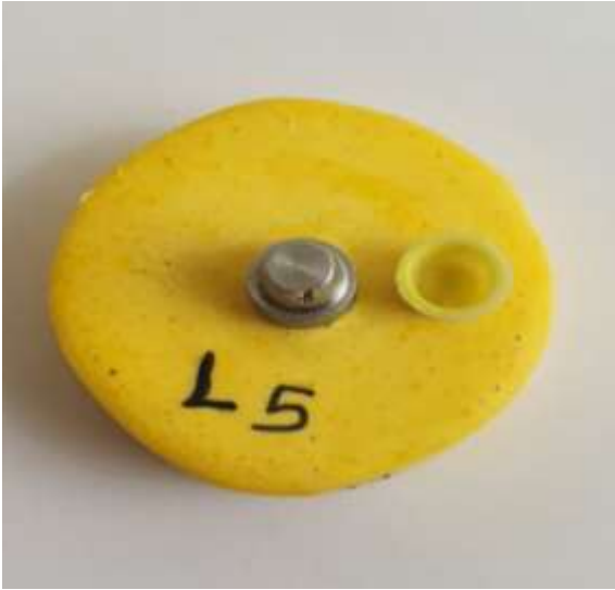
Resim 3.30. Polimerizasyon işlemi tamamlanan akışkan kıvamlı materyalinin alt yapı ile beraber metal daydan ayrılması
