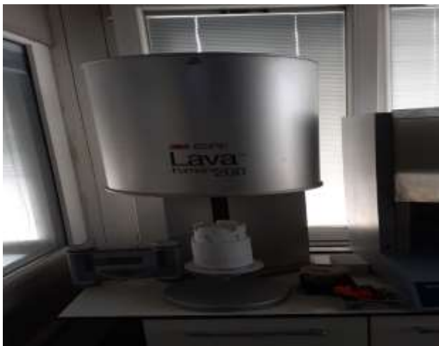
Resim 3.20. Lava alt yapılar için kullanılan sinterleme fırını
