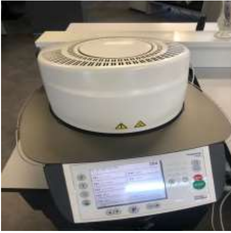
Resim 3.26. Veneerleme ve glaze işlemlerinin yapıldığı fırın
