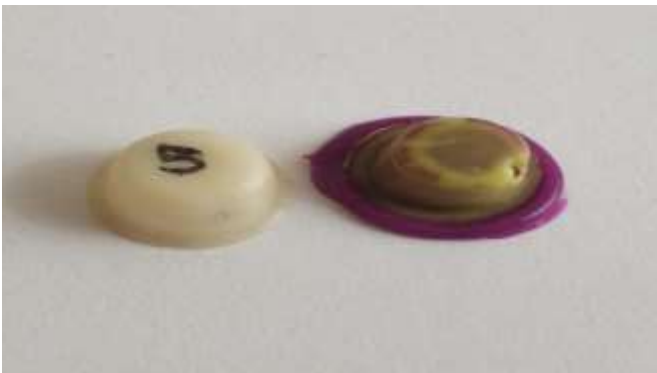
Resim 3.33. Polimerizasyon işlemi tamamlanan silikon replikanın alt yapı materyalinden ayrılması
