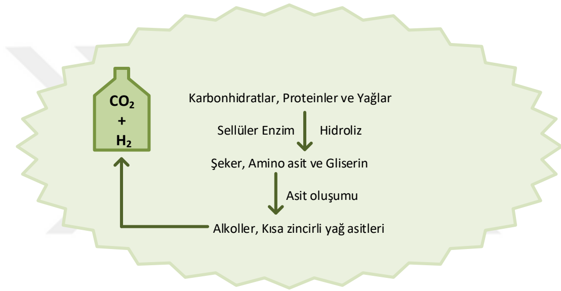
Şekil 4.2 Anaerobik çürütme prosesinin ilk aşaması (hidrojen üretimi)
