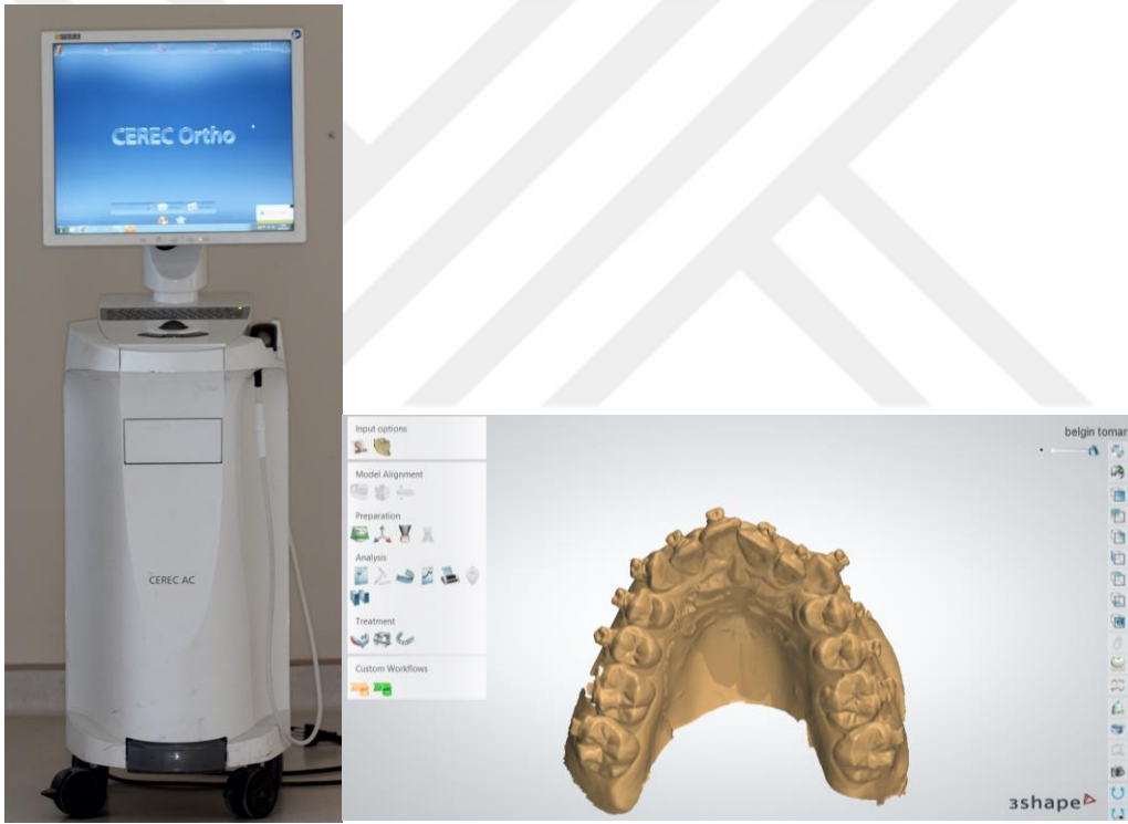
Şekil 3. 2. Ağız içi dijital tarama için kullanılan Cerec Ortho 1.1.2, Dentsply Sirona cihazı ve ağız içi dijital ölçüm örneği
