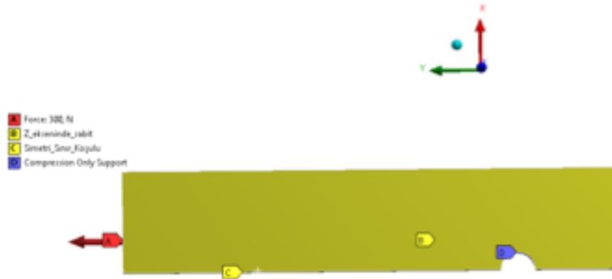
Şekil 3.3 : Kompozit panel pimsiz model.
