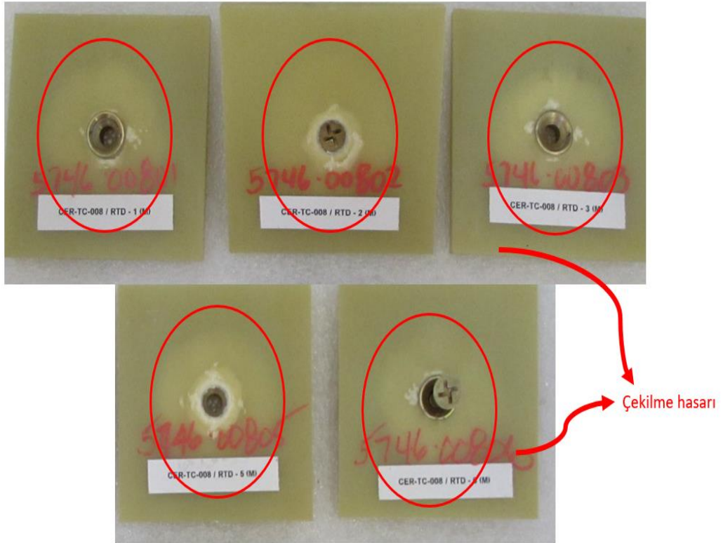
Şekil 4.41 : CER-TP-0001 test sonrası hasar görünümü.
