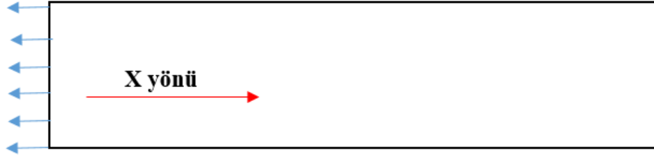
Şekil 3.2 : Kompozit panel –X yönünde deformasyon sınır şartı.
