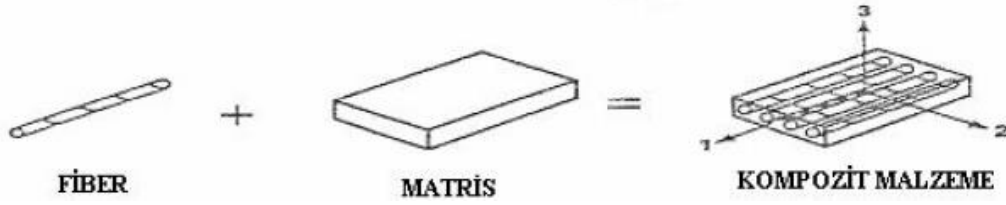
Şekil 1.1 : Fiberli kompozit malzemenin temel yapısı.[1]
