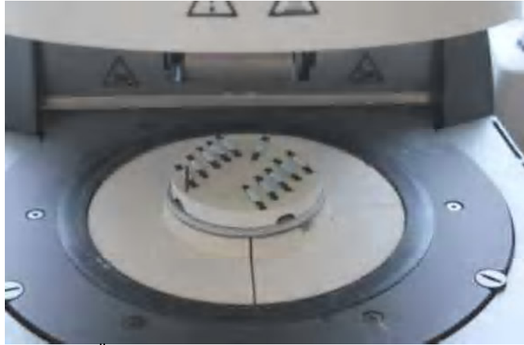
Şekil 3.33 .Üretici firmanın talimatına göre porselen fırınlaması
