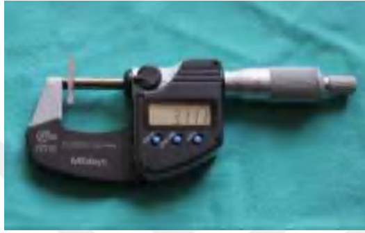
Şekil 3.23. Üretilen metal altyapılarının boyutlarının dijital kumpas ile ölçülerek doğrulanması
