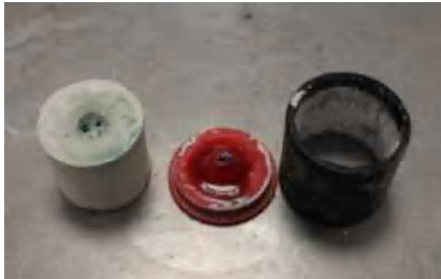
Şekil 3.4. Revatmanın soğutulup manşetten ayrılması
