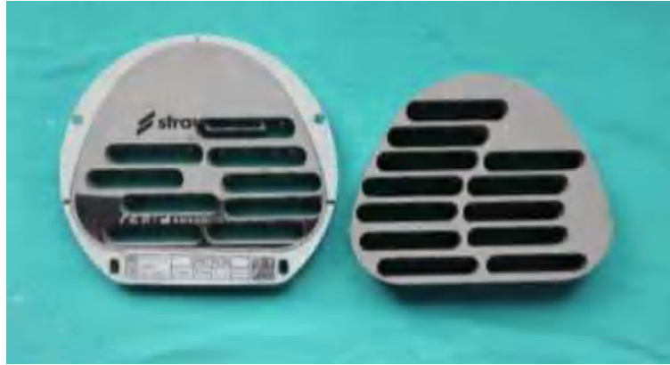
Şekil 3.22. Co-Cr esaslı yumuşak metal bloğun kazıma işlemi sonrası görünümü
