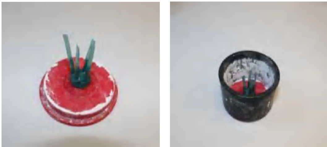
Şekil 3.2. Mum maketlerin bağlantı mumuna sabitlenerek manşete alınması
