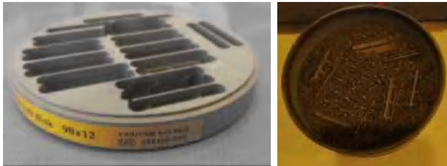
Şekil 3.16. Co-Cr esaslı yumuşak metal bloğun kazıma işlemi sonrası görünümü ve üretilen metal altyapılar
