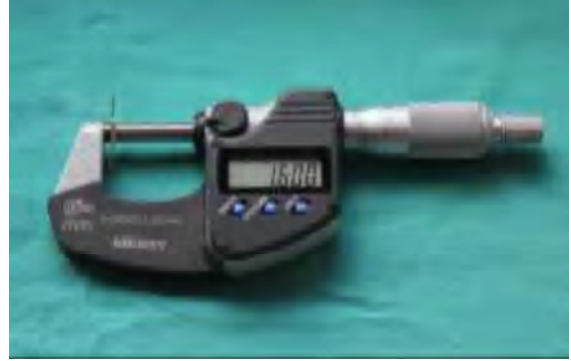
Şekil 3.34. Numunenin son kalınlığı (1.6mm) (metal altyapının (0.5 mm) kalınlığı + seramiğin (1.1 mm) kalınlığı)
