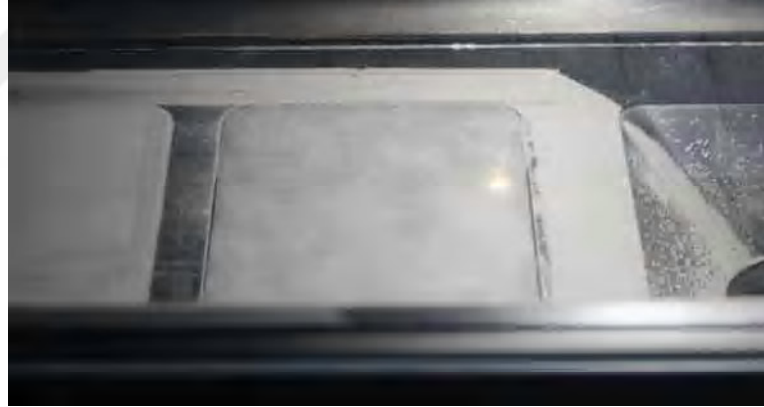
Şekil 3.10. Metal tozlarının lazer ışını kullanılarak birleştirilmesi
