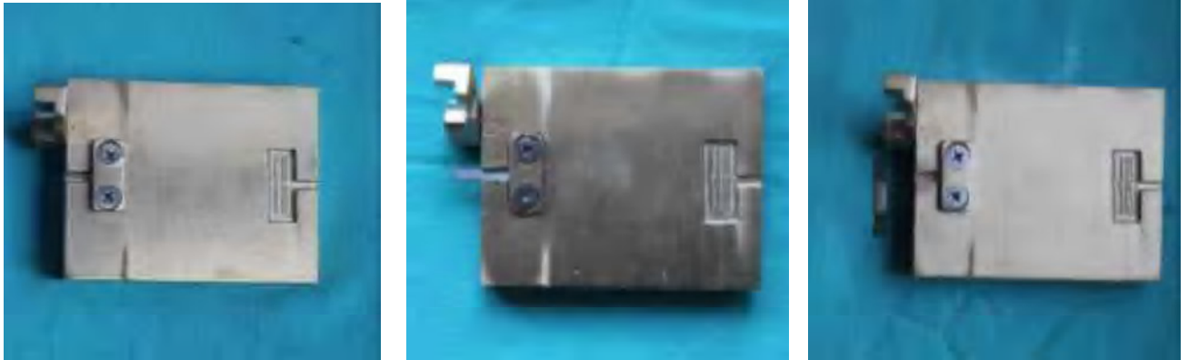
Şekil 3.30. Porselen şekillendirme kalıbına metal altyapının yerleştirilmesi ve opak uygulanması
