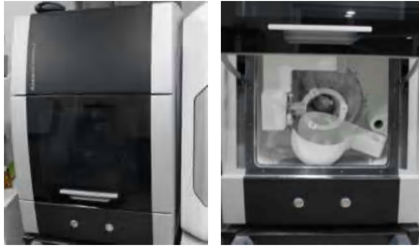
Şekil 3.19. Co-Cr esaslı yumuşak metal blokların kazıma işleminde kullanılan frezeleme makinesi
