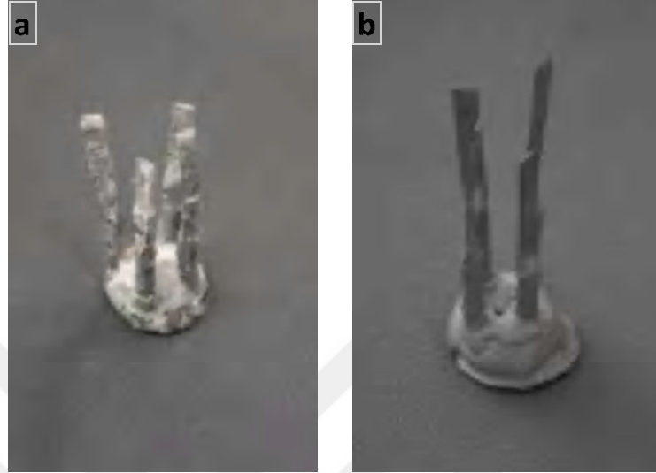
Şekil 3.7. Döküm işlemi sonrası (a) ve temizlendikten sonra (b) metal altyapıların görünümü
