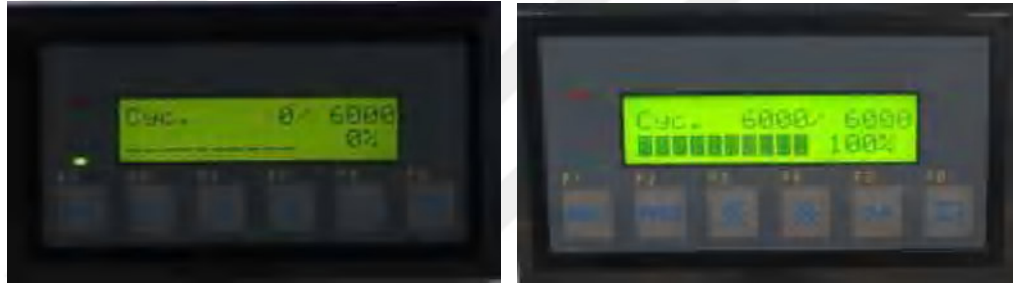
Şekil 3.39. Termal siklusun kontrol paneli ve numunelerin 6000 döngüye maruz bırakılması
