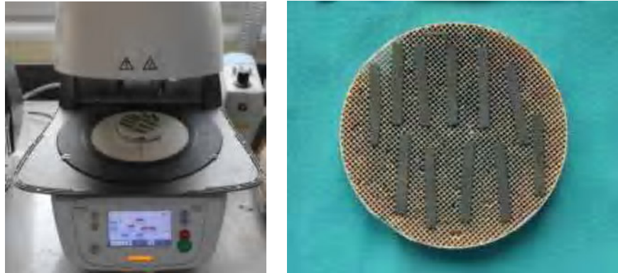
Şekil 3.26. Metal altyapıların üretici firmanın önerilerine göre fırınlanması ve oksidasyon sonrası görünümü
