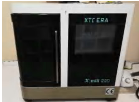
Şekil 3.13. Metal altyapıların üretiminde kullanılacak frezeleme makinesi
