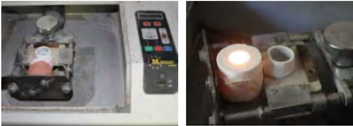
Şekil 3.6. İndüksiyonlu döküm makinesine revetmanın ve döküm potası içinde Co-Cr alaşım bilyelerin yerleştirilmesi
