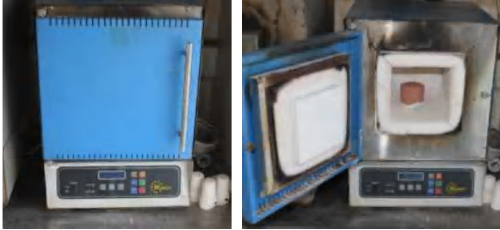
Şekil 3.5. Manşet fırını ve revetmanın ön ısıtma için fırına yerleştirilmesi
