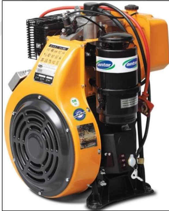
Şekil 3.1. Deneysel çalışmada kullanılan dizel motor (Antor 4 LD 820)
