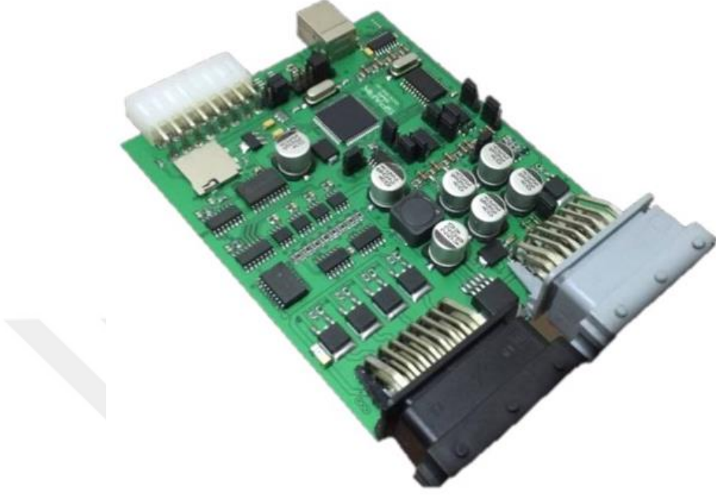
Şekil 3.20. Port enjeksiyon yakıt sistemi elektronik kontrol ünitesi
