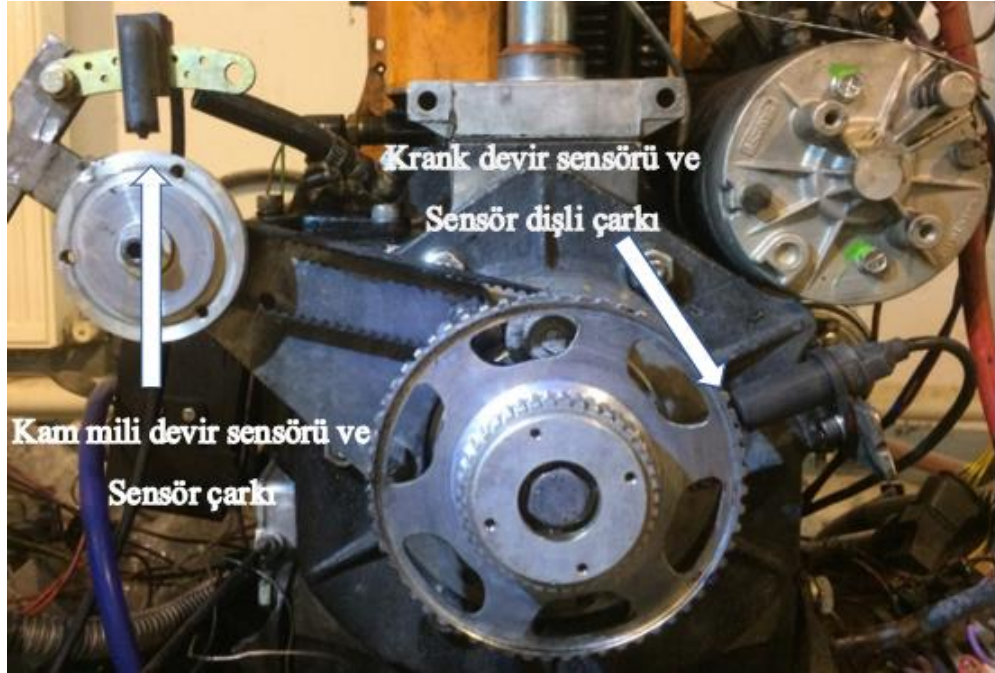
Şekil 3.21. Konum sensörlerinin motor üzerinde bağlantı durumları
