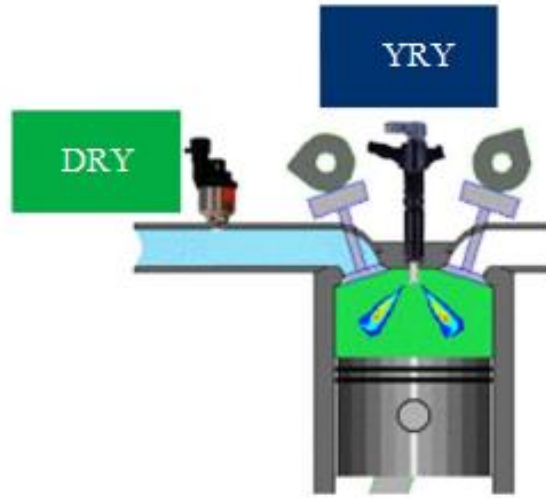
Şekil 1.6. RCCI yanma prosesinin şematik gösterimi (Li vd., 2017)
