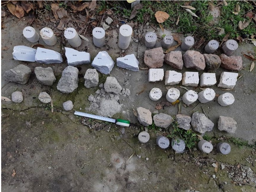
Şekil 5.3. El örnekleri ve karot numunelerinin bir yıllık süre sonunda göstermiş olduğu bozunma davranışı (24/11/2019).
