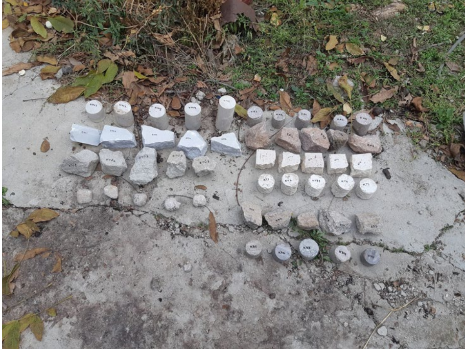
Şekil 5.1. Doğal bozunma süreçlerine bırakılan örneklerin bozunma süreçleri öncesi ilk görüntüsü (24/11/2018).
