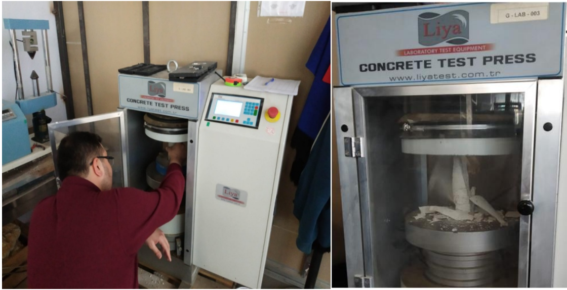
Şekil 6.14. Derlenen örneklerin tek eksenli sıkışma dayanımı deneylerinin yapılışı ve 24.4 kN yük altında travertenden alınan karotun yenilme aşaması.
