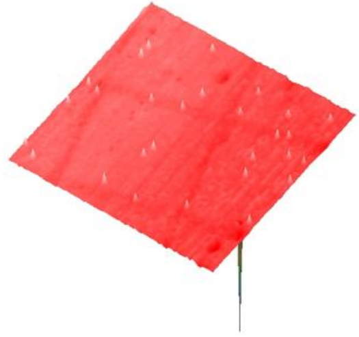
Şekil 85. (a) Yüzeyi yapılandırılmamış 550°C’de 120sn ısıt işlem gören numuneye ait açık devre geriliminin iki boyutlu, (b) üç boyutlu yüzey haritası
