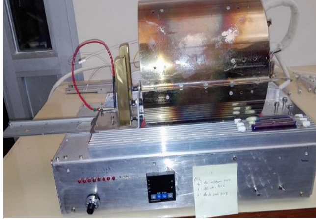
Şekil 24. Laboratuvarımızda yer alan RTA ünitesi
